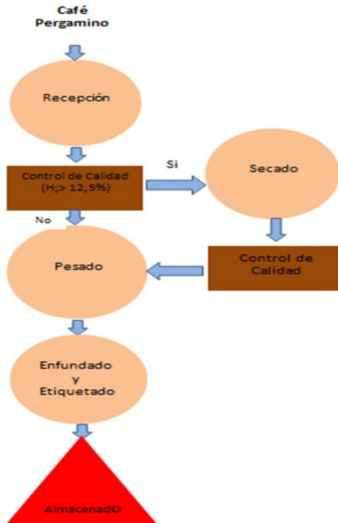
Figura 5: Diagrama de flujo de proceso para obtención de Café Pergamino seco.
