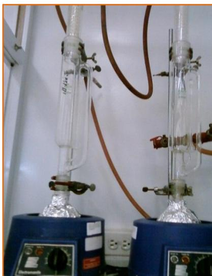
Figura 3. 2. Extracción mediante soxhlet
