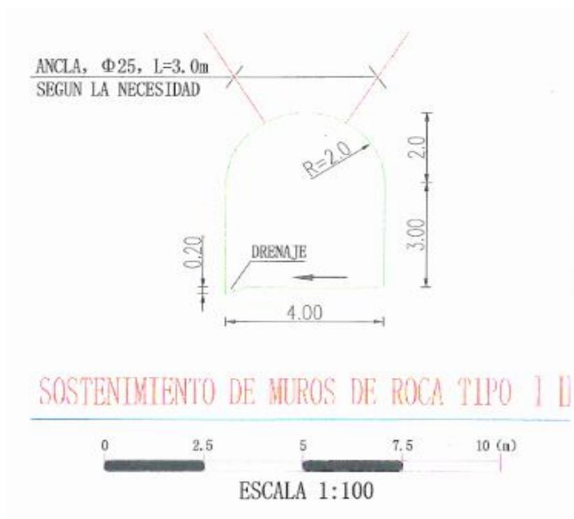
**Figura 2.19:** Diseño de sostenimiento para macizo I y II.
