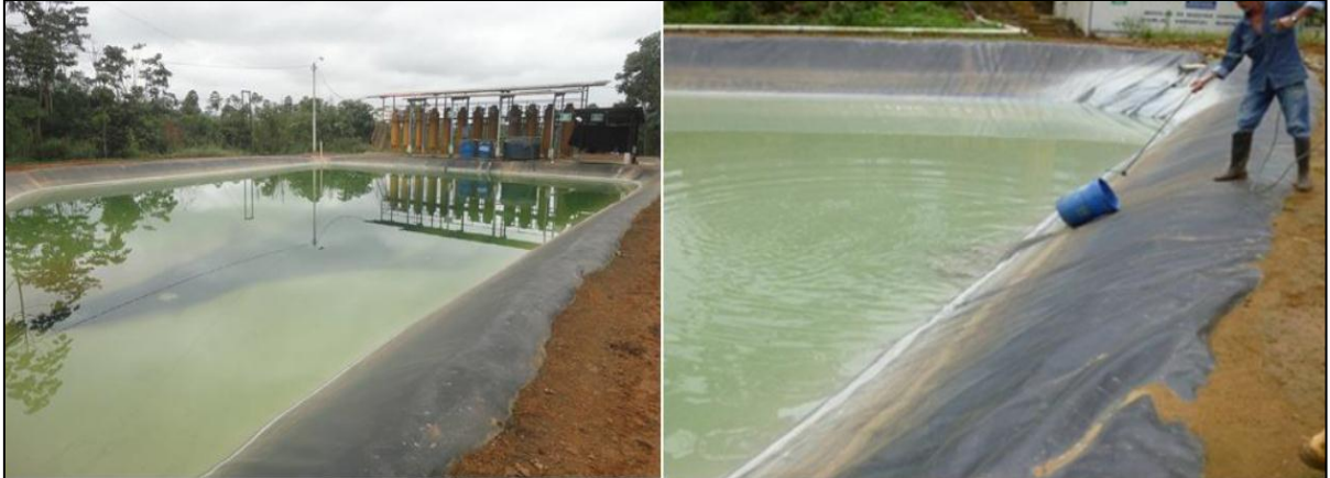
Figura 17. Muestreo del efluente cianurado a 280 ppm CN - en piscina primaria de empresa Orenas S.A.
