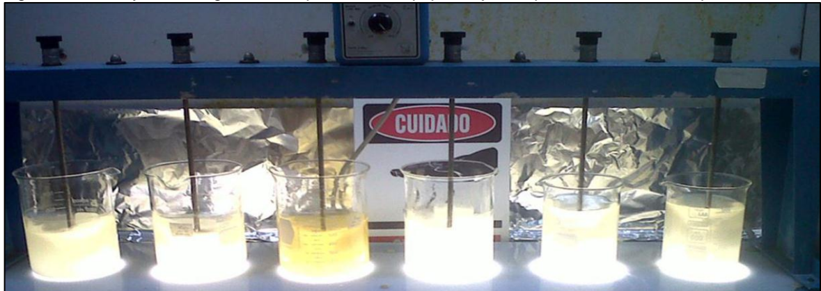
Figura 18. Ensayos de degradación química en equipo de jarras para el tratamiento químico.
