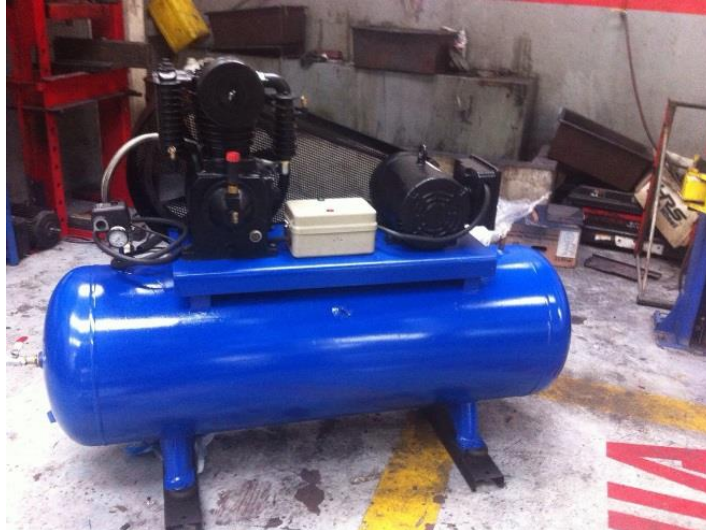
Foto # 18 – Compresor Bellair
