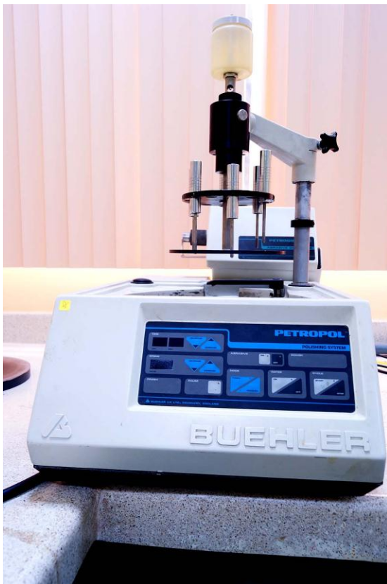
Fotografía10. Pulidora láminas delgadas PETROPOL BUEHLER.
