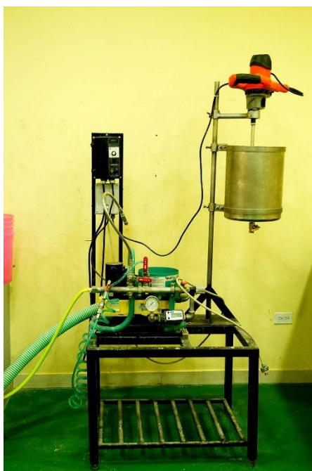
Fotografía18. Equipo de concentración (KC-MD3 y Agitador)
