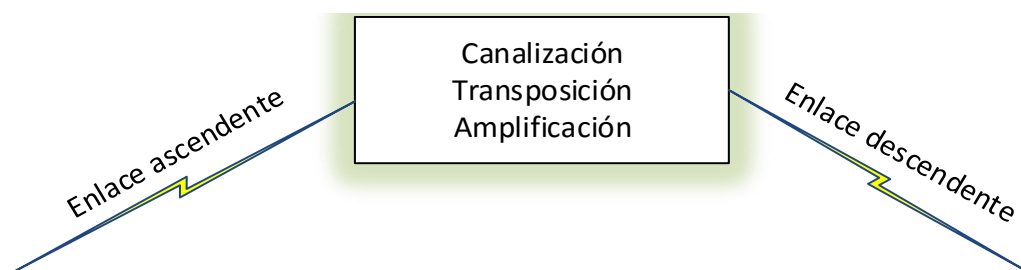
Figura 2.2.- Funciones básicas de un transponder . Fuente: Imagen propia de los autores, basado en [2].
