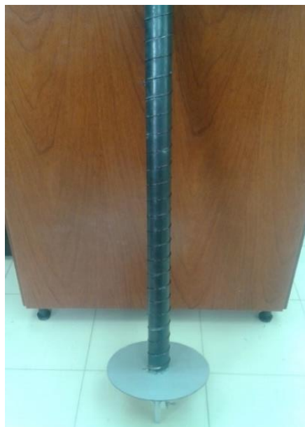
Figura 3.25.- Antena helicoidal implementada para 1,7 GHz. Fuente: Imagen propia de los autores.
