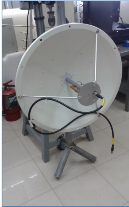
Figura 3.29.- Antena parabólica con alimentador helicoidal. Fuente: Imagen propia de los autores.
