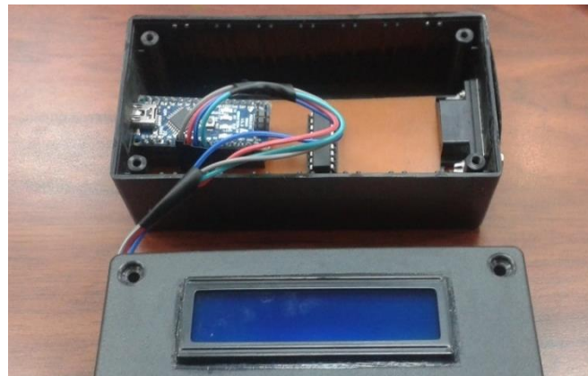
Figura 3.10.- Placa del controlador del rotor en su case. Fuente: Imagen propia de los autores.
