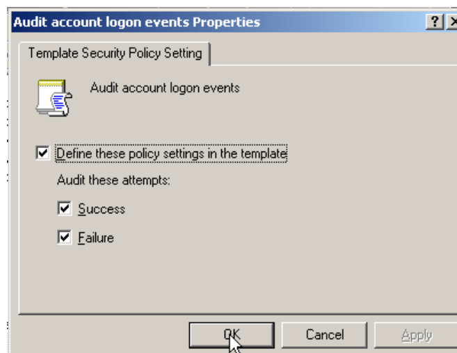
Figura 3.2.8. Habilitación de la Auditoría de sucesos de inicio de sesión de cuenta
