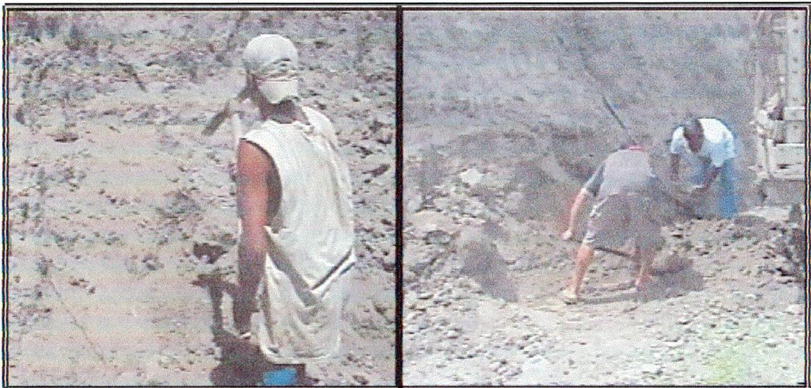
**Figura 4.4** Extracción manual de la arcilla.
