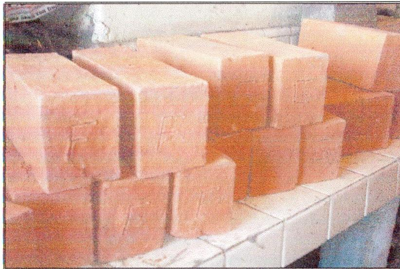
Figura 5.1 Ladrillos elaborados en la primera dosificación
