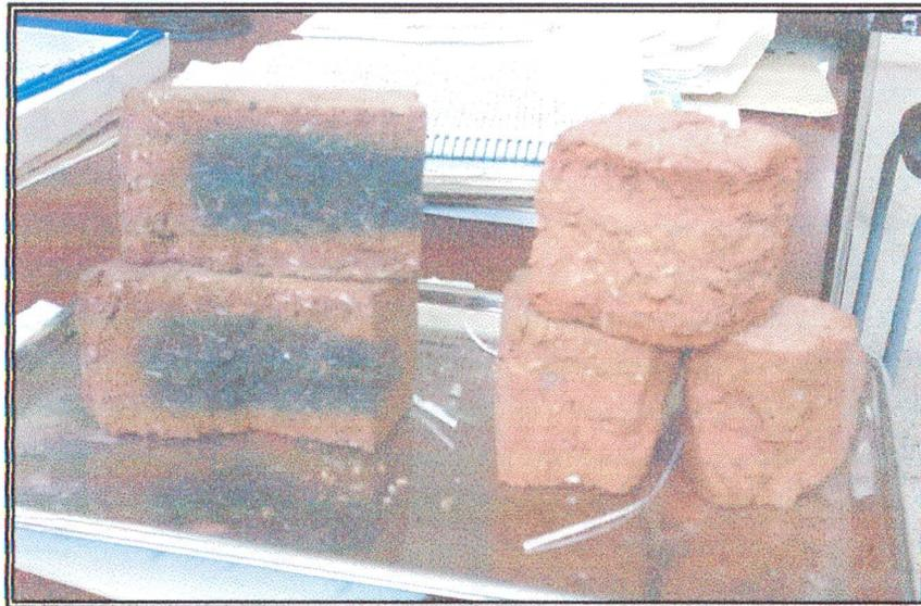
Figura 5.4 Diferente cocción en ladrillos
