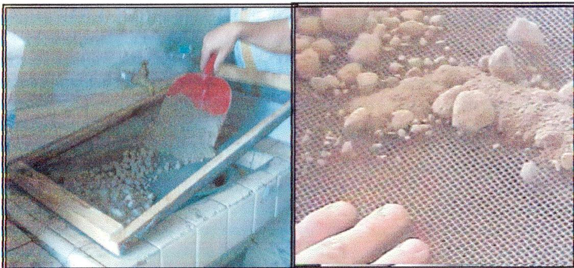
**Figura 4.6** Tamizado de las arcillas
