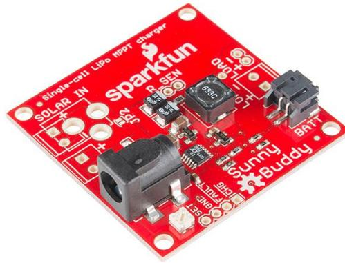
Figura 4. 30. Cargador solar MPPT.
