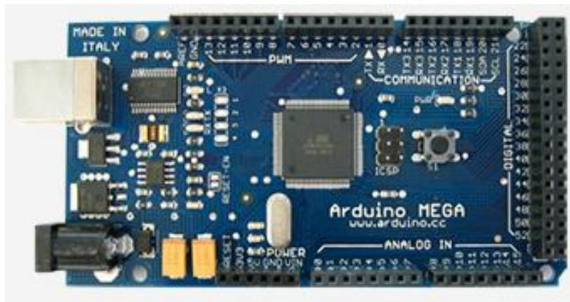
Figura 3. 2. Dispositivo Arduino Mega
