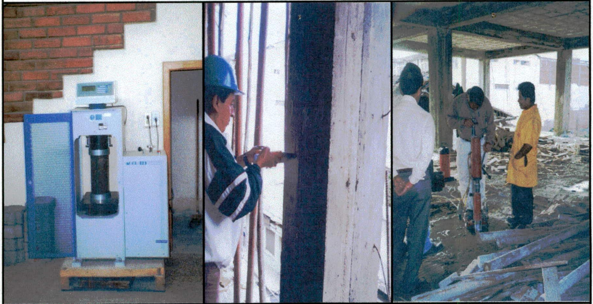
Control de hormigones mediante pruebas de compresión, esclerometrías y extracción de núcleos
