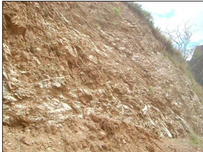
Foto No. 4: Esquistos: dirección foliación N 300^{\circ} y buzamiento N 65^{\circ} E
