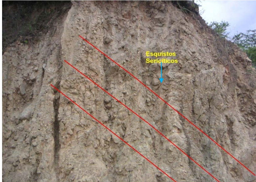
Foto 4: Esquistos sericíticos: dirección foliación N 145° e inclinación 40° NE
