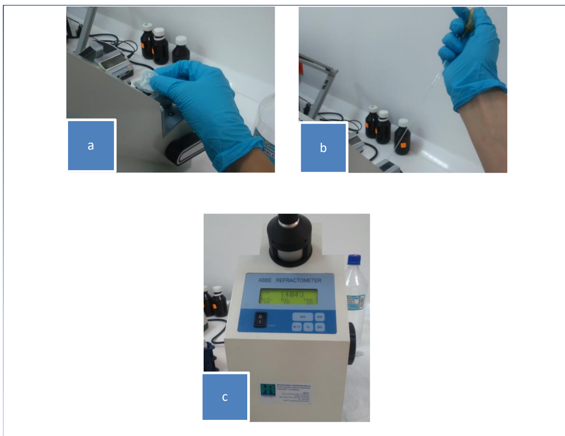
Figura 23. Proceso de determinación del índice de refracción.
