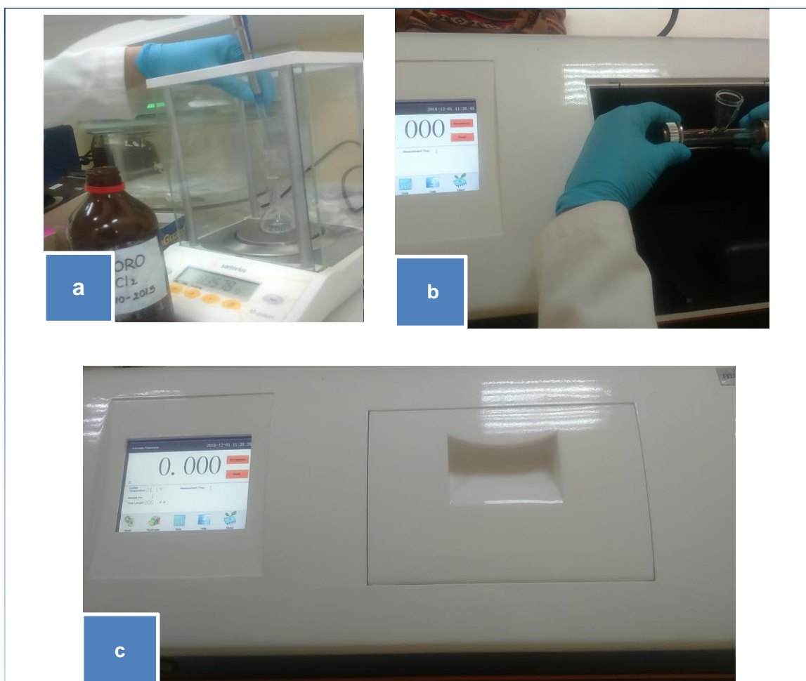
Figura 24. Proceso para la determinación de la actividad óptica específica. a) Preparación de la muestra. b) Ubicación de la celda en el equipo. c) Lectura. Elaborado por: La autora.
