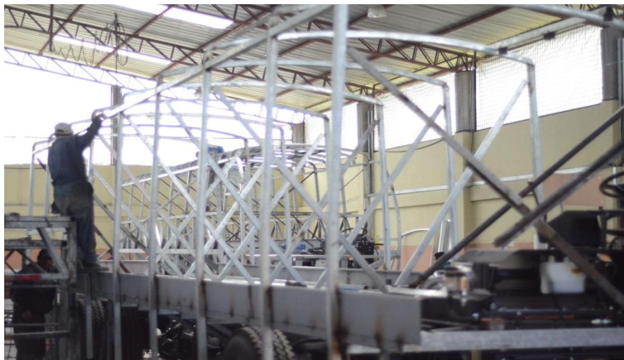
Figura 2. 2 Estructura del bus
