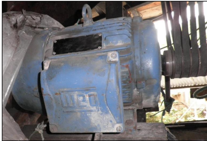
Foto. 20. Motor eléctrico modelo WEG-W22_IE1 90.2%. Fuente: D. Guamán, 2015.
