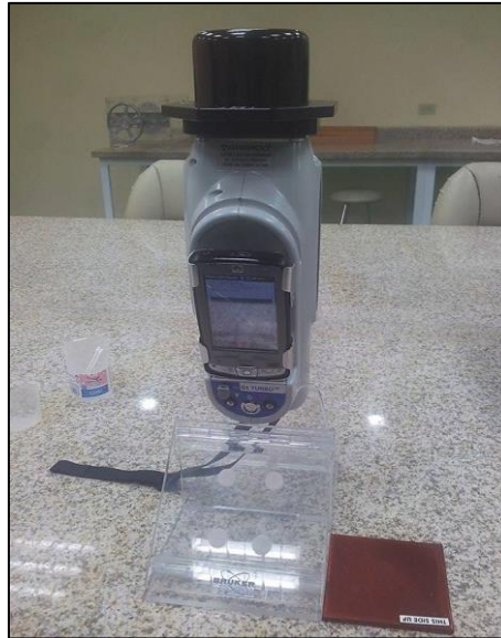
Foto. 13. Equipo de Fluorescencia de Rayos X, BRUKER S1. Fuente: D. Guamán, 2016.
