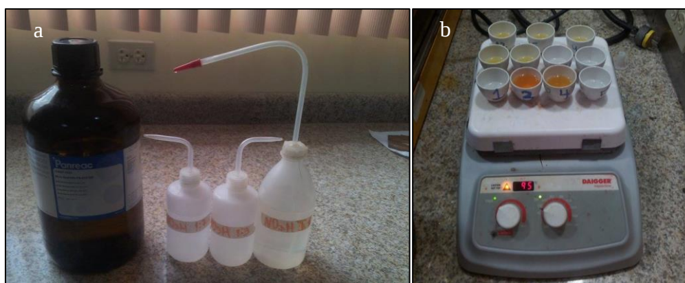
Foto. 18. a. Ácido Nítrico en sus diferentes concentraciones. b. Digestión del dore. Fuente: D. Guamán, 2016.
