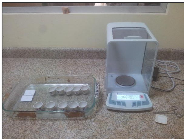
Foto. 17. Cuantificación de los dores en micro balanza. Fuente: D. Guamán, 2016.
