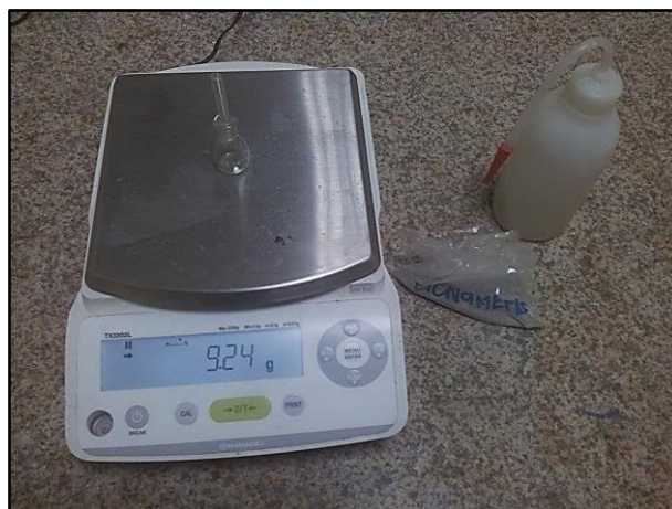
Foto. 11. Materiales usados para el ensayo del picnómetro. Fuente: D. Guamán, 2016.
