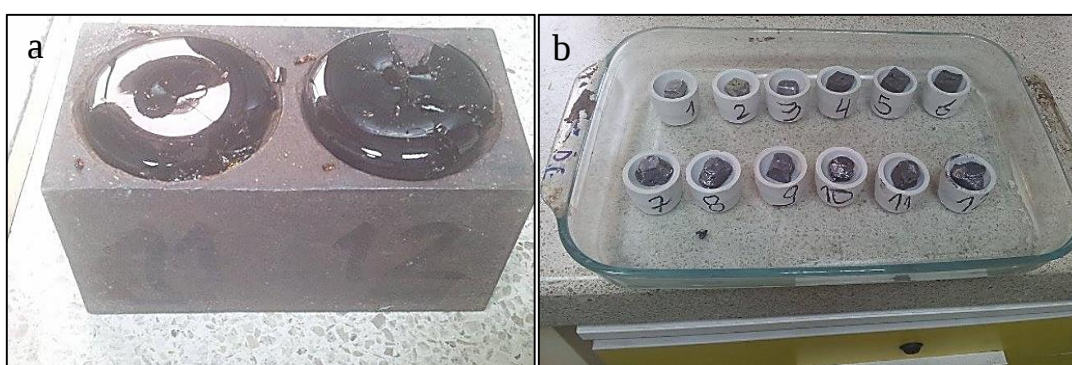
Foto. 15. a. Régulos de plomo con escoria después de sacar del proceso de Fusión. b. Régulos de plomo limpios listos para el proceso de copelación. Fuente: D. Guamán, 2016.
