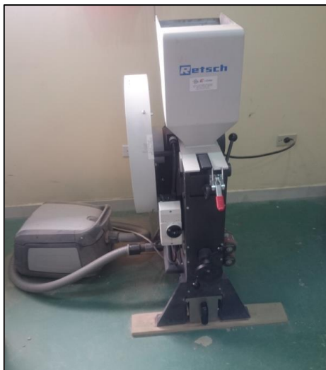
Foto. 8. Trituradora de muelas, RETSCH. Fuente: D. Guamán, 2015.
