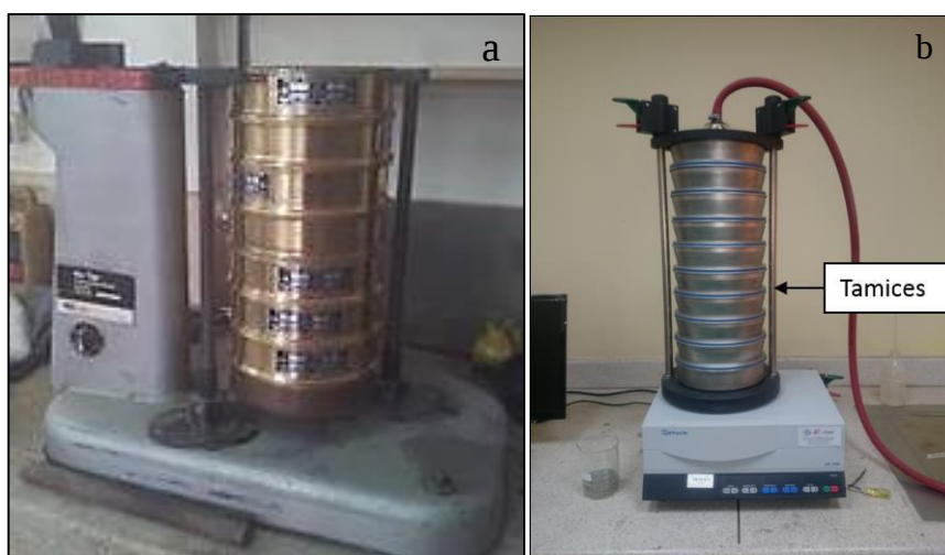
Foto. 12. a. Ensayo granulométrico serie gruesa. b. Ensayo granulométrico serie fina. Fuente: D. Guamán, 2016.
