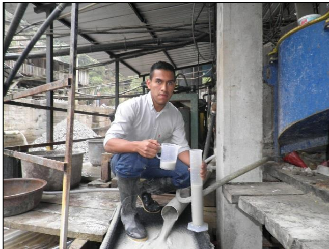
Foto. 4. Toma de muestra del P2, salida de tubería. Fuente: D. Guamán, 2015.
