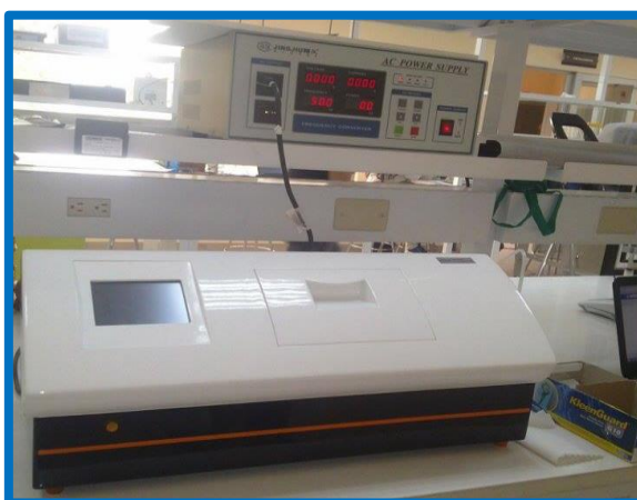
Figura 18. Polarímetro digital Fuente: La autora.
