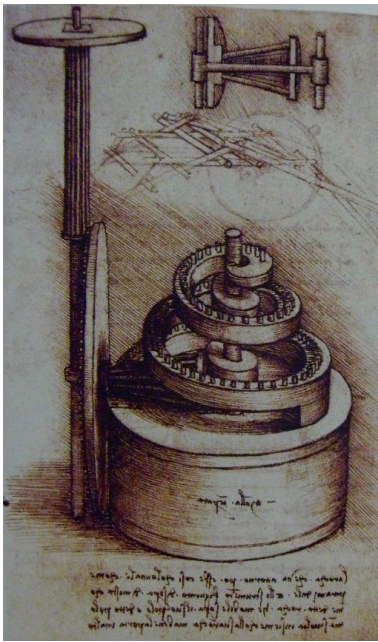
Ilustración 21 Resorte templado con rueda escalonada. Anterior a 1493-1497.
