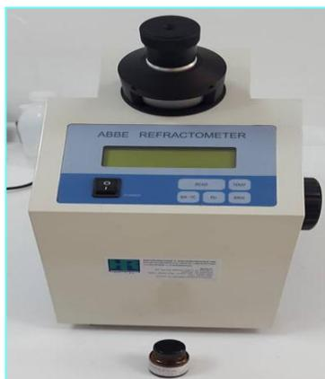
**Figura 36.** Refractómetro ABBE
