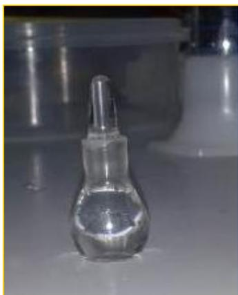
**Figura 34.** Picnómetro con agua destilada
