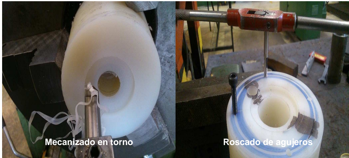
Figura 96. Cilindrado interior y roscado manual de los soportes de motores paso a paso. Fuente: El Autor
