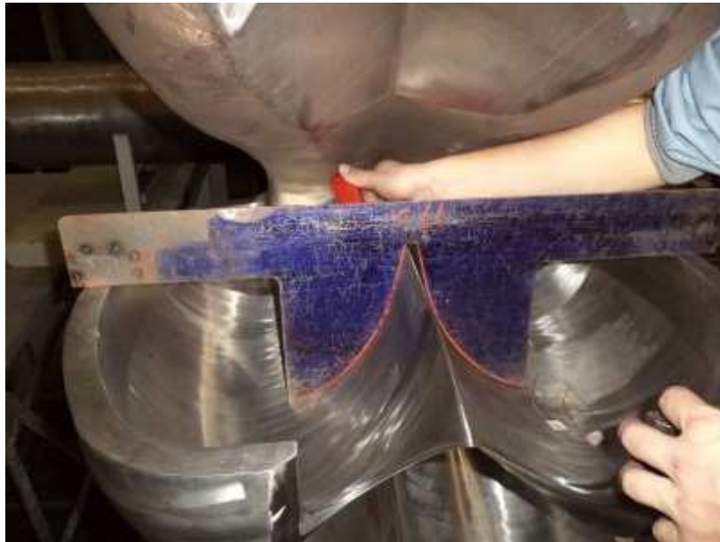
Figura 2. Verificación del perfil hidráulico del álabe con ayuda de las plantillas Fuente: El Autor
