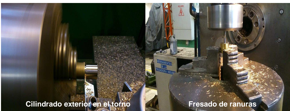
Figura 94. Mecanizado en torno y fresado de los acoples. Fuente: El Autor.
