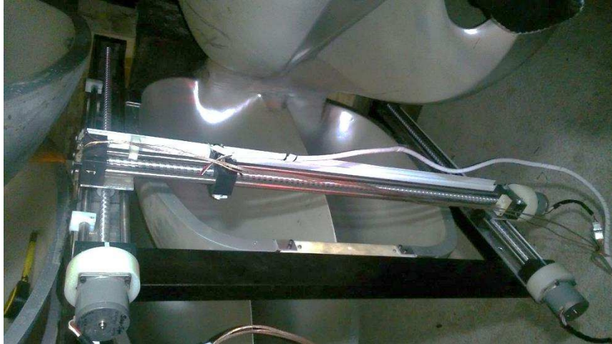
Figura 99. Montaje del PM3D sobre el álabe de la turbina Pelton. Fuente: El Autor
