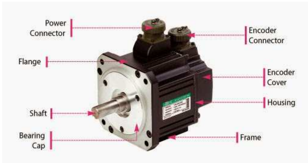
Figura 27. Componentes de un servomotor.
