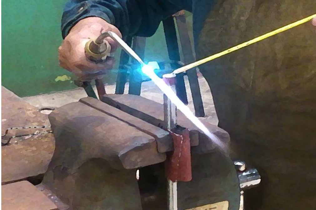
Figura 92. Proceso de construcción de las guías de los ejes X e Y. Fuente: El Autor
