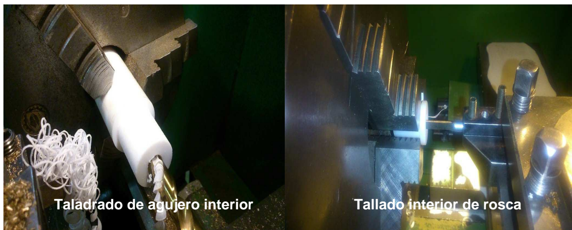
Figura 95. Cilindrado y roscado de tuerca husillo. Fuente: El Autor
