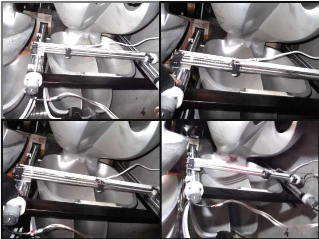
Figura 100. Escaneado del perfil hidráulico del álabe de la turbina Pelton. Fuente: El Autor
