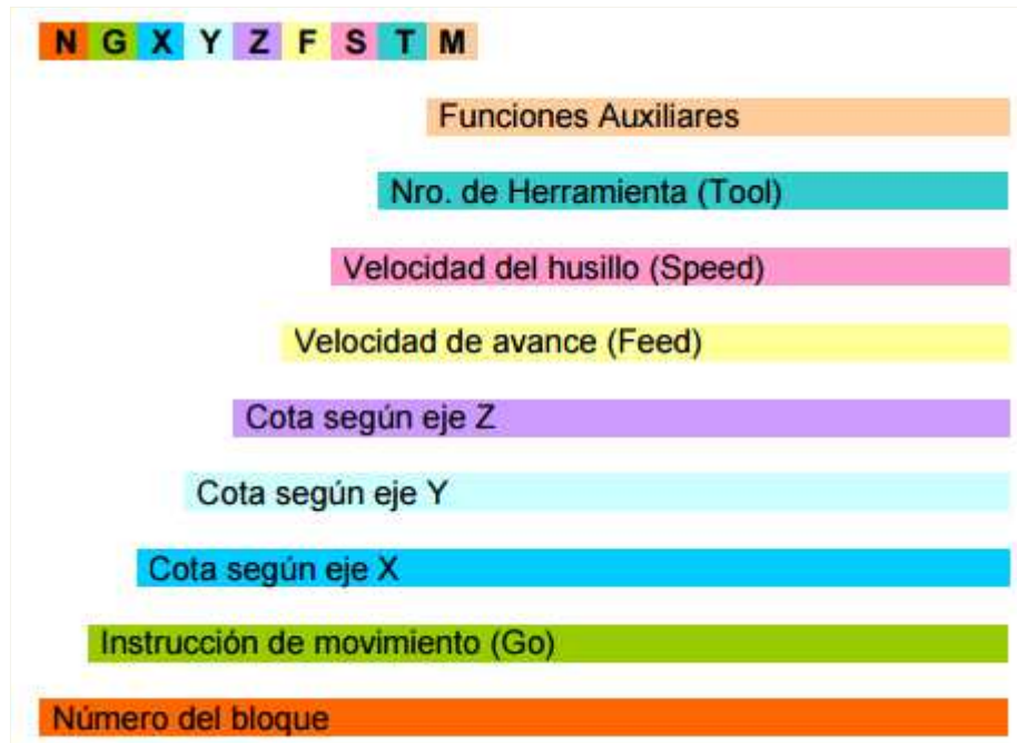
Figura 51. Estructura de un bloque de instrucciones Código G. Fuente: (Gulminelli, 2016)
