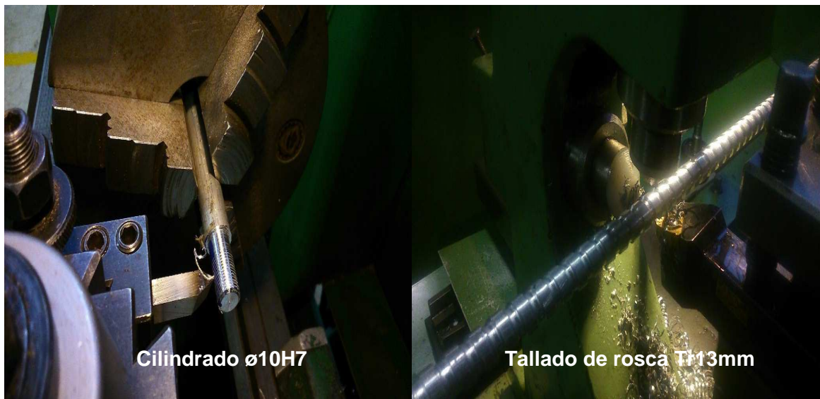
Figura 93. Cilindrado y roscado de tornillo en el torno universal. Fuente: El Autor
