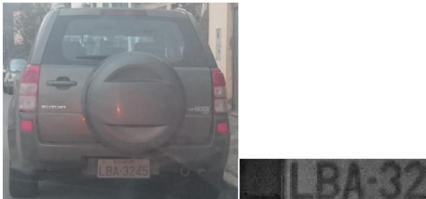
Figura 78. Vehículo y detección de la región de placa parcial.
