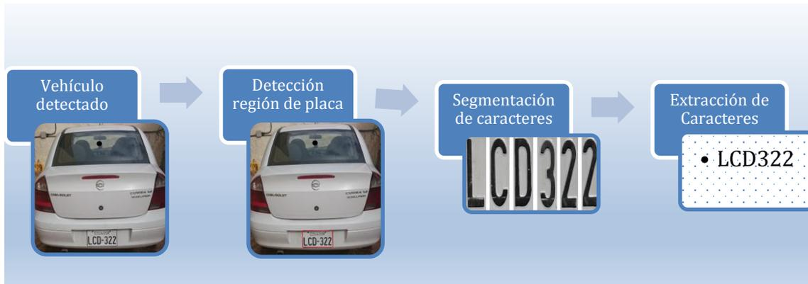
Figura 3. Fases de un Sistema para la detección de los caracteres de la placa en vehículos.
