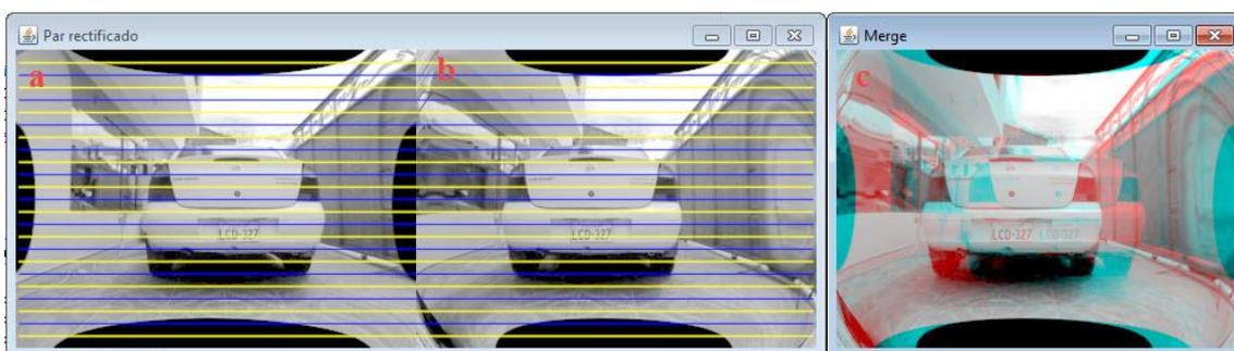
Figura 65. a) Rectificación imagen izquierda, b) Rectificación imagen derecha y c) Correspondencia de imágenes.
