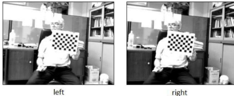
Figura 42. Par de imágenes para calibración estéreo.
