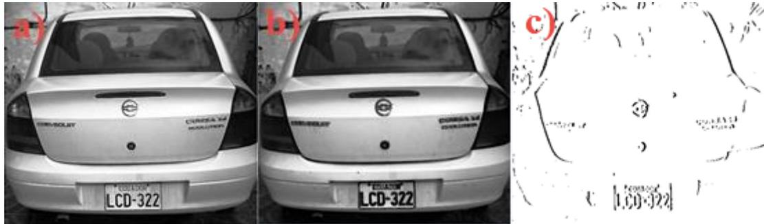
Figura 77. a) Imagen ecualizada, b) Imagen dilatada y c) Generación de áreas candidatas.
