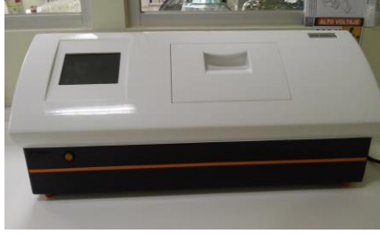
Figura 8. Equipo de rotación óptica. Fuente: (Autora, 2016)
