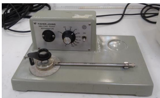
Figura 3. Equipo Fisher-Johns-Melting Point Apparatus para determinar punto de fusión.
