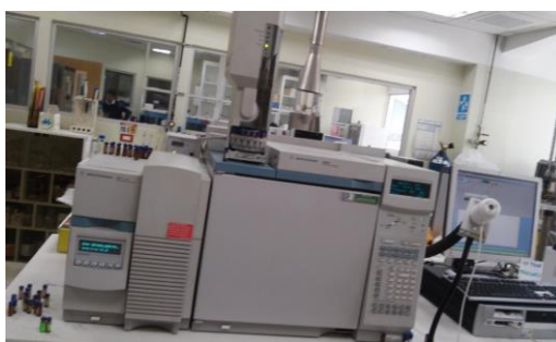
Figura 6. Cromatógrafo de gases acoplado a espectrómetro de masas utilizado.
