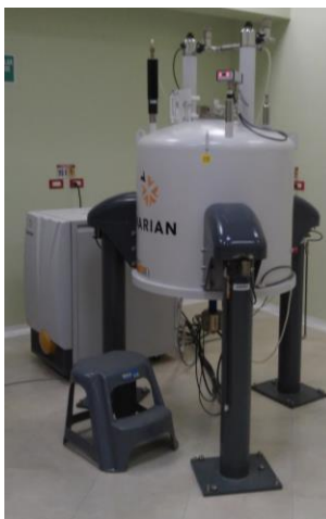
Figura 7. Equipo de resonancia magnética nuclear utilizada. Fuente: (Autora, 2016)
