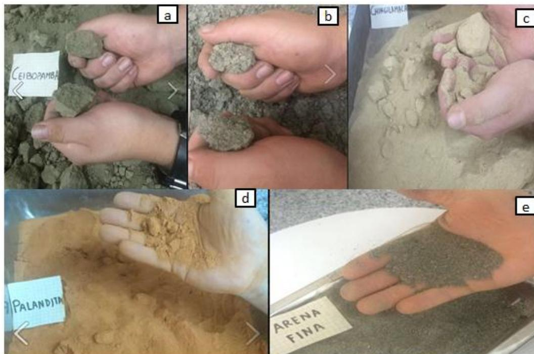
Figura 27. Ensayo de consistencia: a) Ceibopamba; b) Cangahua; c) Chinguilamaca; d) Palanda; e) Arena Fina.
