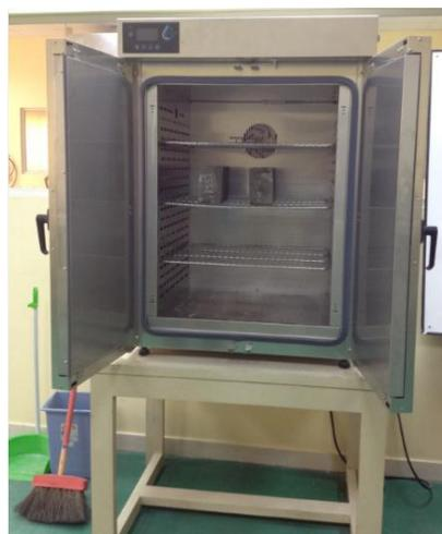
Figura 68. Secado en la estufa de ladrillos con mezcla óptima.
