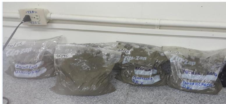
Figura 53. Hidratación de la mezcla en fundas cerradas herméticamente.
