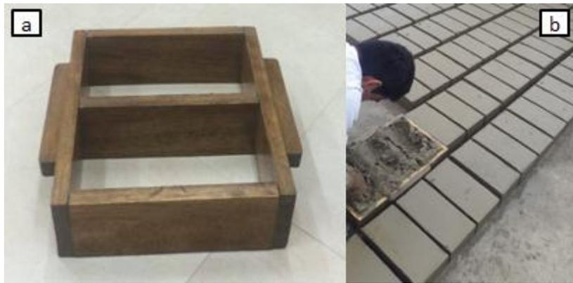
Figura 78. Productores artesanales. (a) Molde de madera; (b) Moldeo de ladrillos
