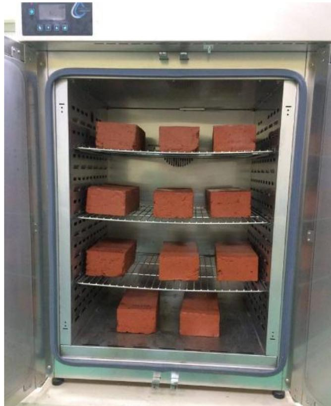
Figura 72. Secado a la estura para obtener el peso sumergido de ladrillos con mezclas óptimas.
