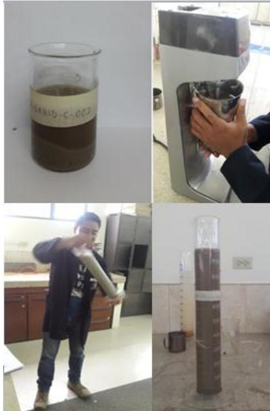
Figura 30. Ensayo de granulometría por el método del hidrómetro.
