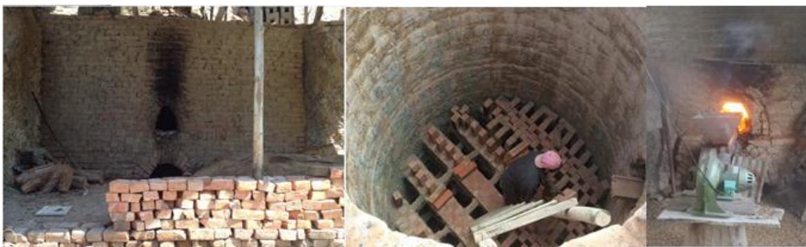
Figura 80. Horno de cocción de ladrillos colocación y quemado.
