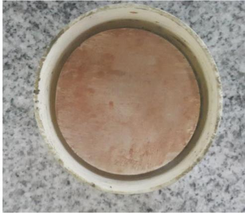
Figura 58. Contracción luego de la quema al horno.
