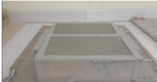
Figura 67. Moldeo de ladrillos producidos con mezcla óptima.
