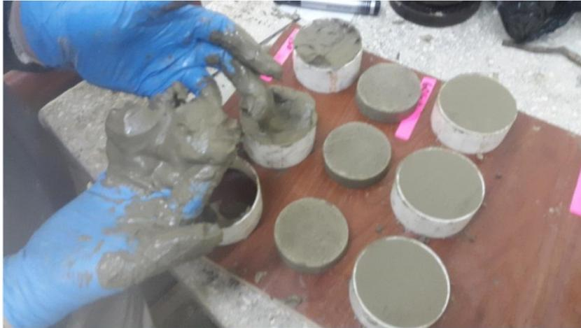
Figura 62. Mezclado y moldeo manual de discos a 500° C y 700° C.
