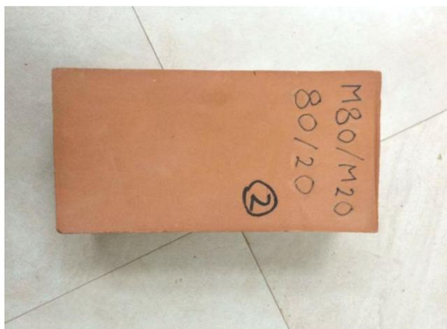
Figura 64. Ladrillo producido con la mezcla óptima de Ceibopamba y Cangahua en 80%/20% respectivamente.
