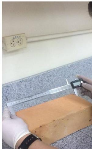
Figura 75. Medición de la longitud para el ensayo de variación dimensional
