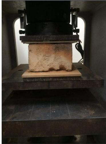
Figura 74. Prensa ACUTEK para el ensayo de compresión simple en ladrillos.
