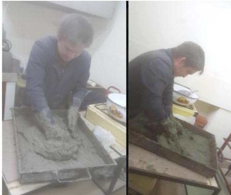
Figura 65. Amasado a mano de ladrillos producidos con la mezcla óptima.
