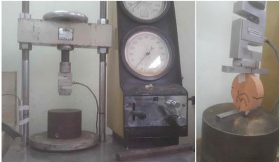
Figura 47. Equipo Versa Tester para compresión diametral.
