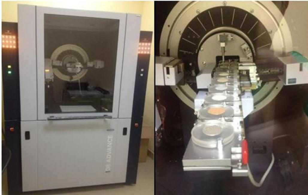
Figura 45. Equipo para difracción de rayos X.
