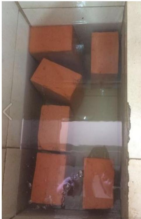
Figura 71. Sumersión de ladrillos con mezcla óptima durante 24 horas.
