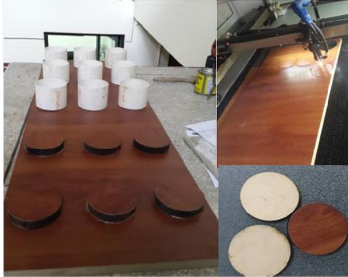
Figura 50. Proceso de elaboración de moldes para discos de compresión diametral.
