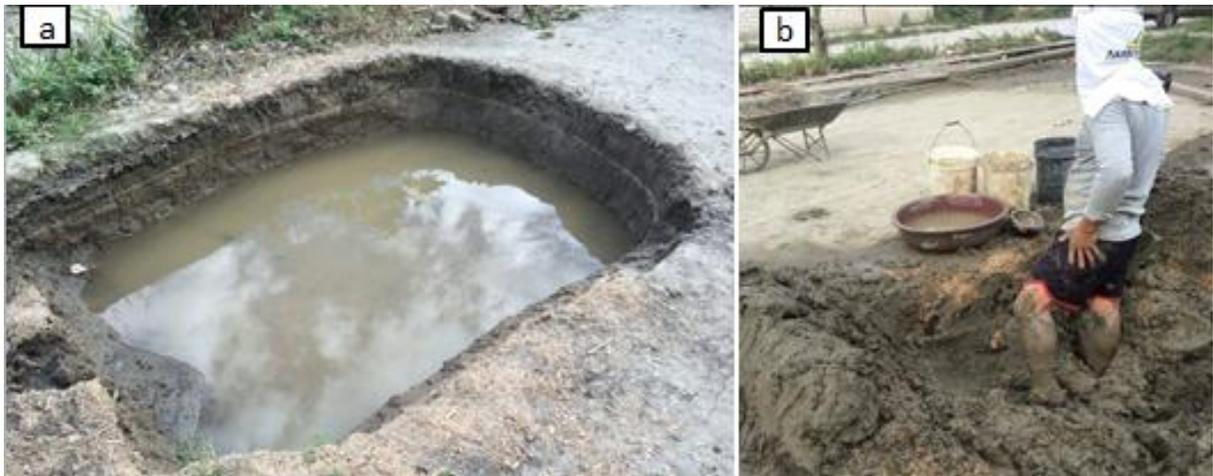
Figura 77. Productores artesanales. (a) Hidratado de la materia prima; (b) amasado de la materia prima
