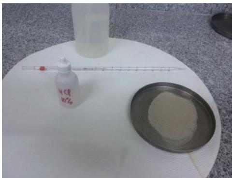
Figura 36. Equipo para determinación de carbonatos.
