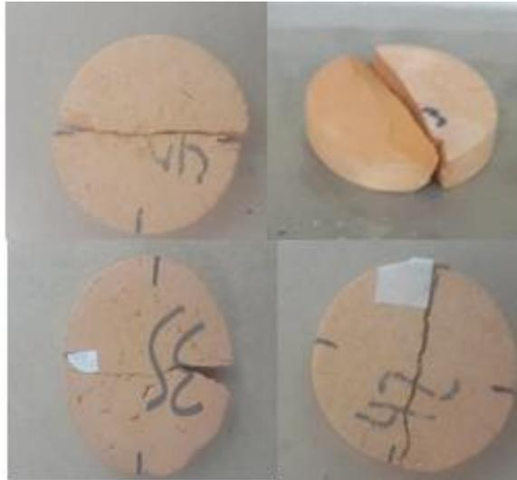
Figura 60. Modos de ruptura del ensayo de compresión diametral.
