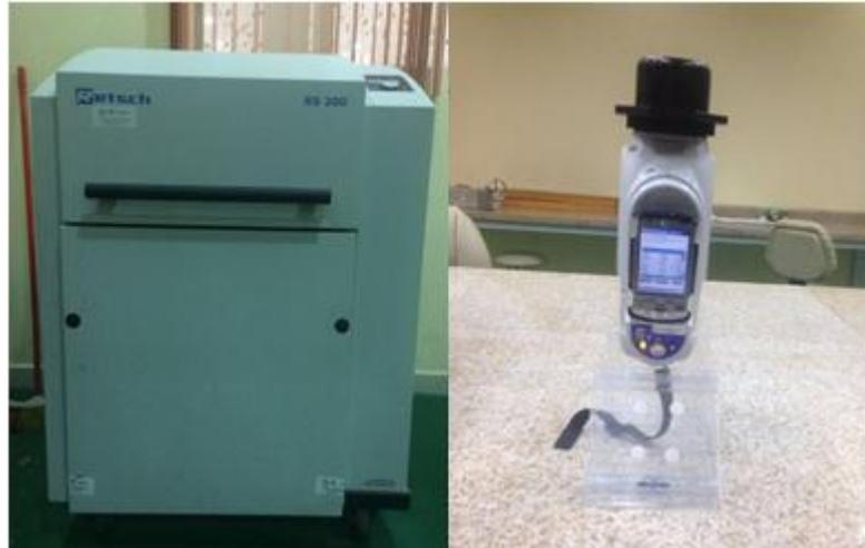
Figura 39. Equipo para pulverizar muestras (izq); Equipo para ensayo de F.R.X (der).
