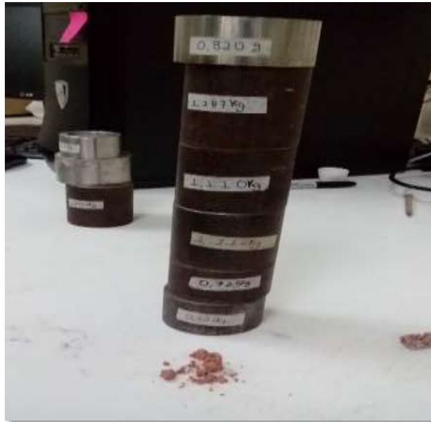
Figura 10 Esponja cerámica calcinada y rota por las masas de acero. Fuente y elaboración: La autora.
