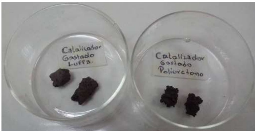
Figura 30 Catalizador de paladio/alúmina soportado en esponjas cerámicas con moldes de Luffa y Poliuretano desactivados.
