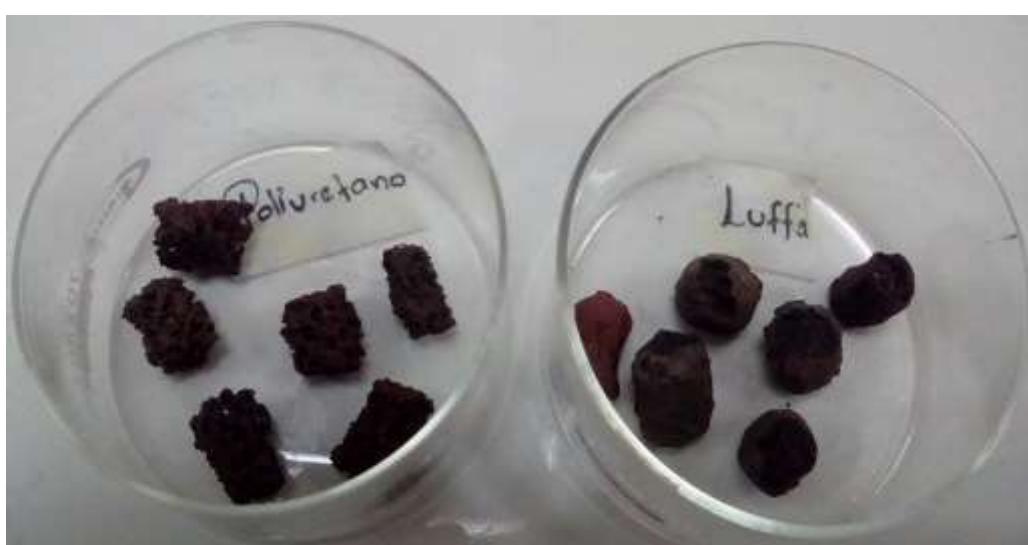
Figura 21 Catalizador de paladio/alúmina soportado en esponjas cerámicas con moldes de Luffa y Poliuretano.
