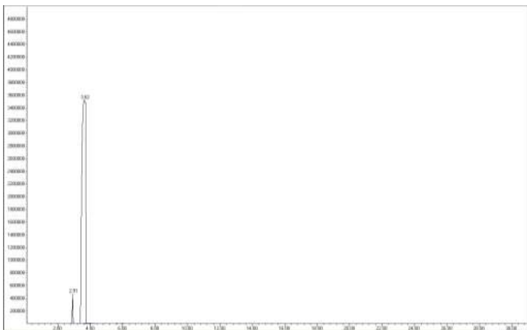
Figura 35 Perfil del cromatograma del análisis de catalizador soportado en esponjas de poliuretano.
