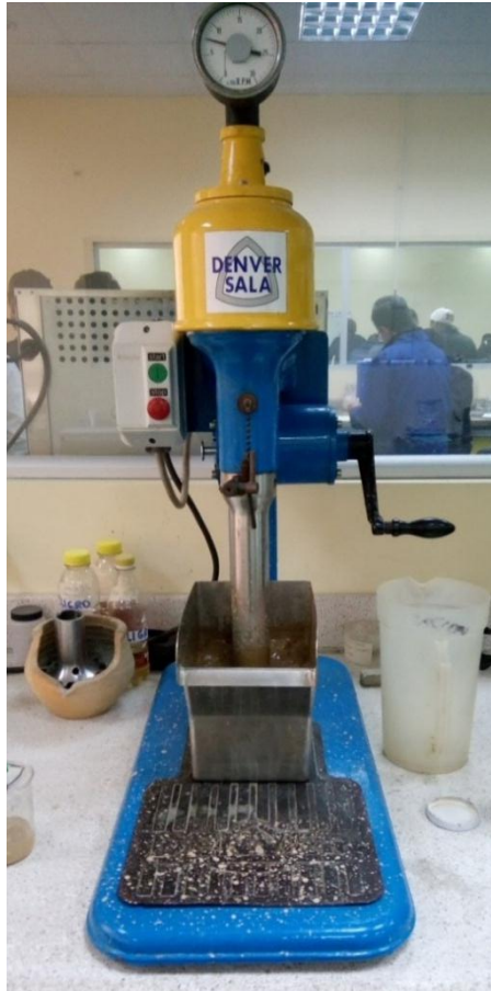
Ilustración 11: Celda de flotación Denver Sala Elaboración: David Cuenca
