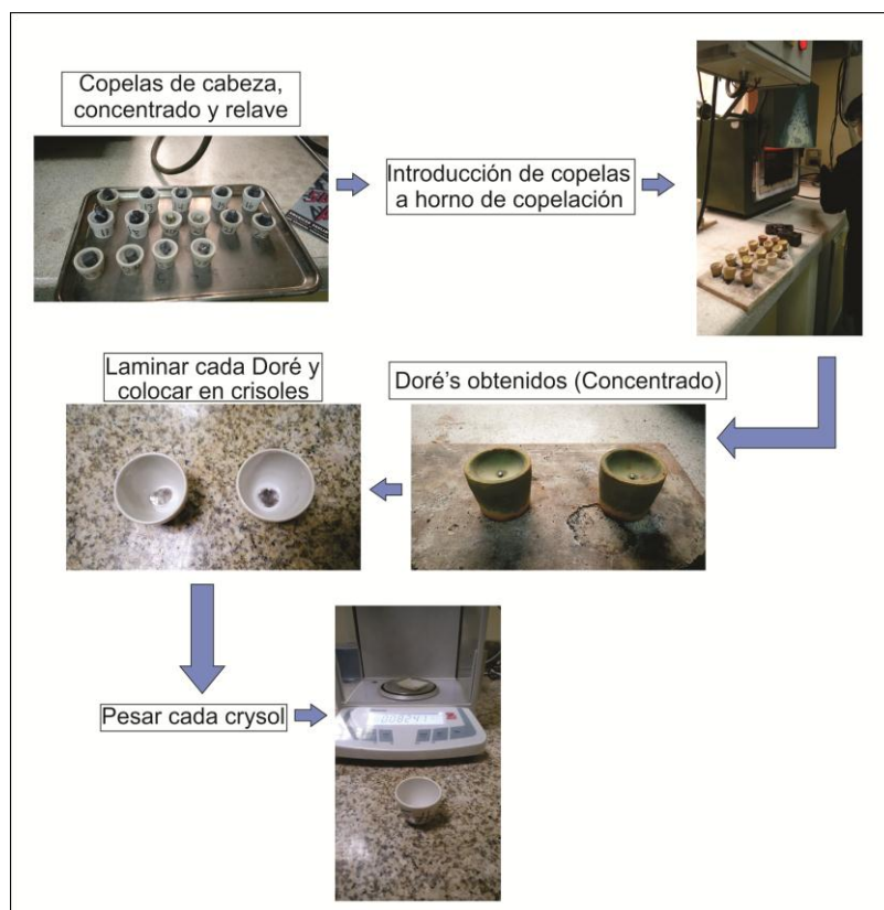
Ilustración 13: Proceso de Copelación Elaboración: David Cuenca
