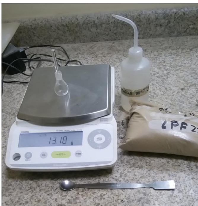
Ilustración 9: Material usado para determinar peso específico Elaboración: David Cuenca
