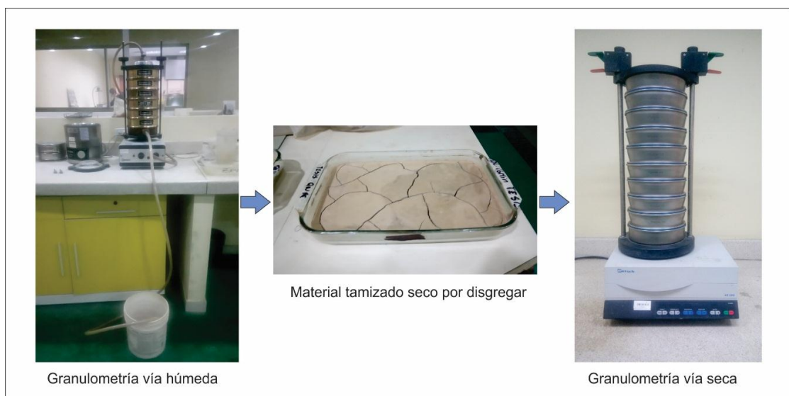
Ilustración 10: Proceso de tamizado Elaboración: David Cuenca
