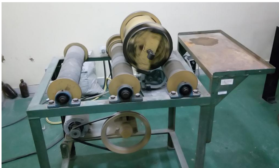
Ilustración 8: Molino de Bolas marca Batch Elaboración: David Cuenca
