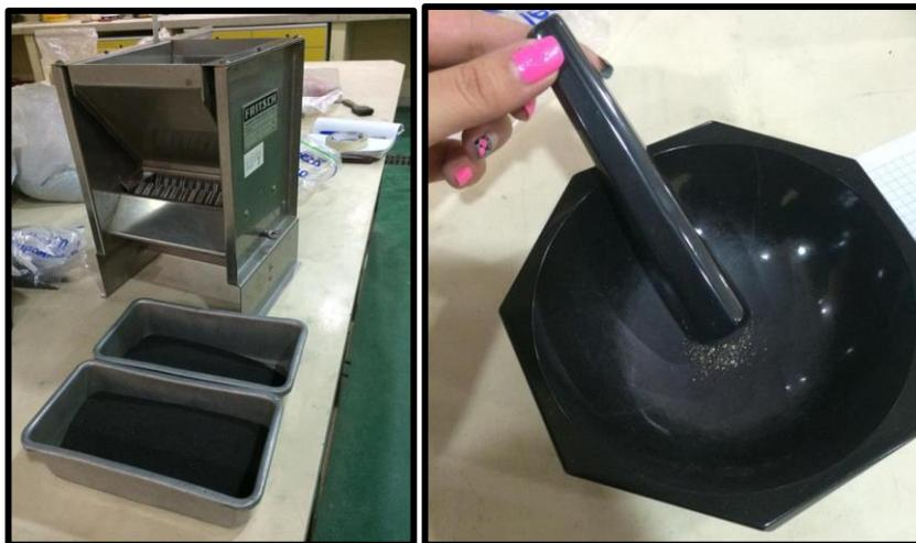
Figura 18. Proceso de cuarteo y pulverización.
