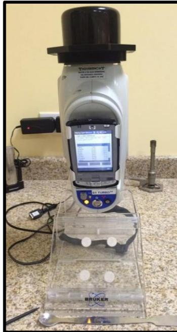
Figura 17. Equipo de XRF portátil marca Bruker.
