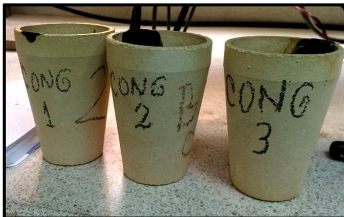
Figura 19. Preparación de la muestra en los vasos de fundición.
