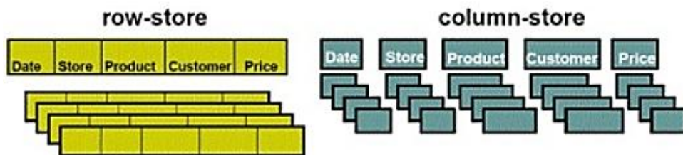
Figura 4. Bases de datos de Columnas
