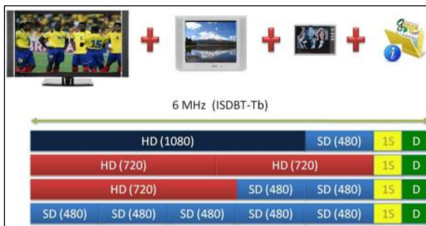
Figura 1.1. Múltiple canalización del canal radioeléctrico de televisión digital.
