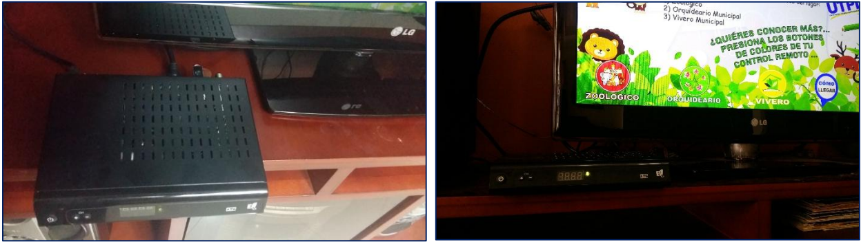
Figura 4.19. Conexión de EITV Developer Box con pendrive mediante USB y televisor LG mediante HDMI. Fuente: Creado por el autor mediante fotografías del ambiente de ejecución, STB conectado a LG.
