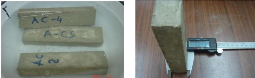
**Figura 4.27** Proceso realizar la prueba de absorción.
