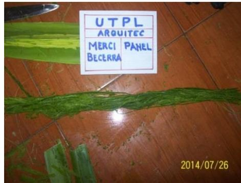
**Figura 2.24:** Hojas en proceso de desfibrado para la extracción de la fibra.
