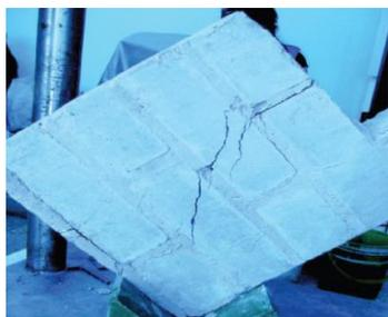
**Figura 3.15:** Bloques de suelo grueso estabilizado con cal.
