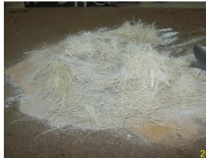
**Figura 3.18:** Estabilización con fibras.
