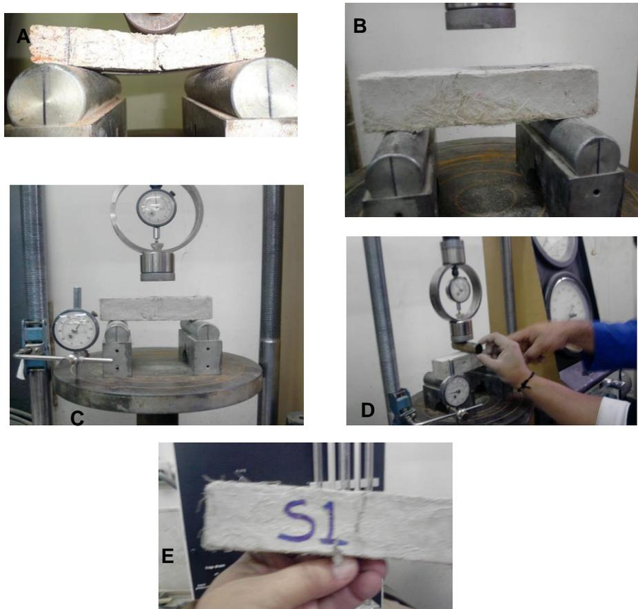
**Figura 4.25:** **A:** Medir y trazar los puntos de apoyo en probetas; **B; C; D:** Situar la probeta y calibrado de máquina. **E:** falla del material.
