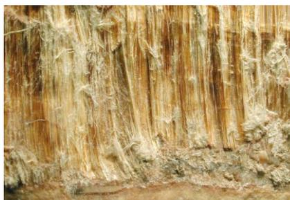
**Figura 2.3:** Fibras de asbesto.
