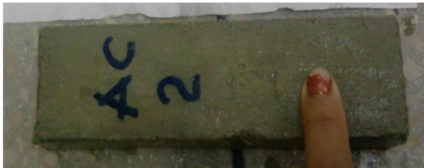
**Figura 4.22:** Muestra luego de 24 horas inmersa en agua.
