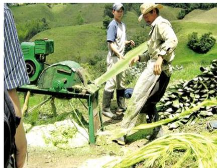
**Figura 2.18:** Desfibrado mecánico.
