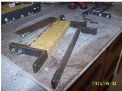
**Figura 4.1:** desmoldado de probeta.
