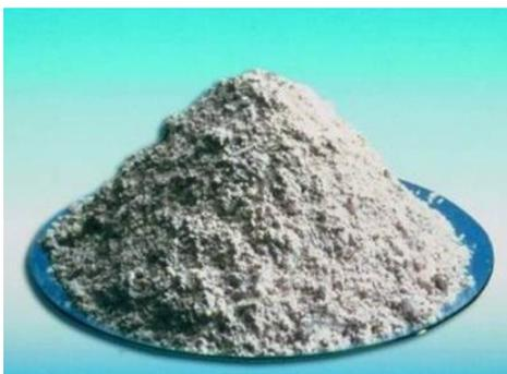
**Figura 4.11:** Cal hidratada
