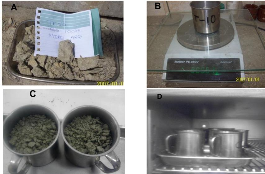
**Figura 4.3:** A, B, C, D: Procedimiento para determinar  $W$  del suelo.
