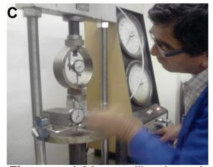
**Figura 4.21:** calibrado de máquina.
