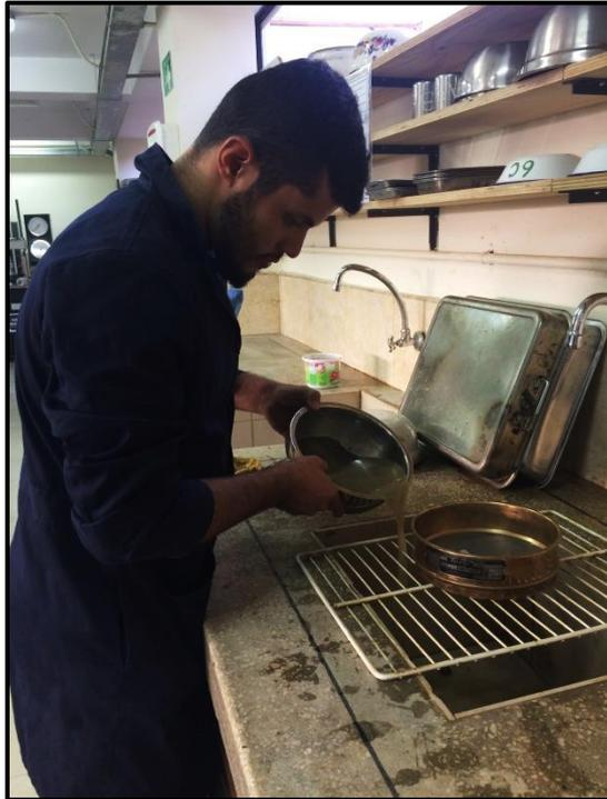
**Fotografía No. 3** Lavado de la fracción fina del ensayo de granulometría
