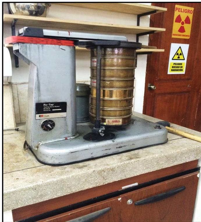
**Fotografía No. 2** Tamizado de fracción gruesa en granulometría.
