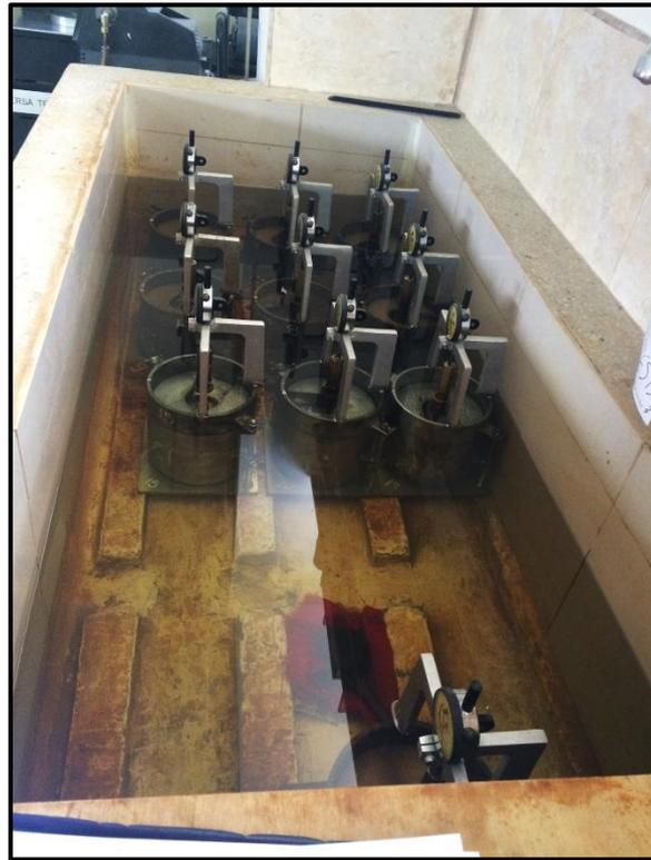
**Fotografía No. 9** Moldes en saturación para ensayo CBR.
