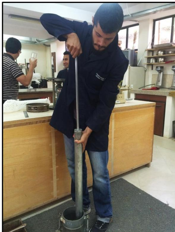
**Fotografía No. 8** Ensayo de Compactación
