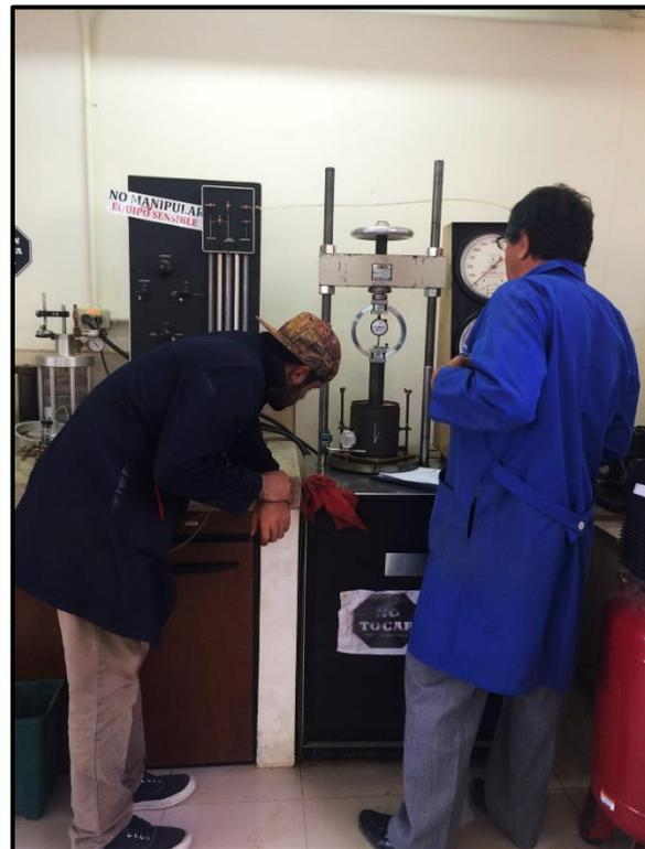
**Fotografía No. 10** Lecturas en la máquina de penetración en CBR
