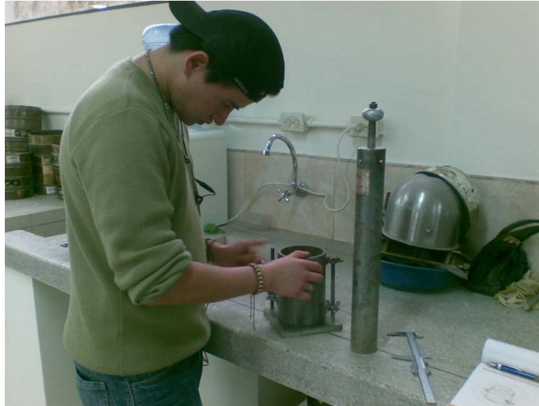
Figura 5.4. Preparación del equipo para ensayo de permeabilidad en laboratorio
