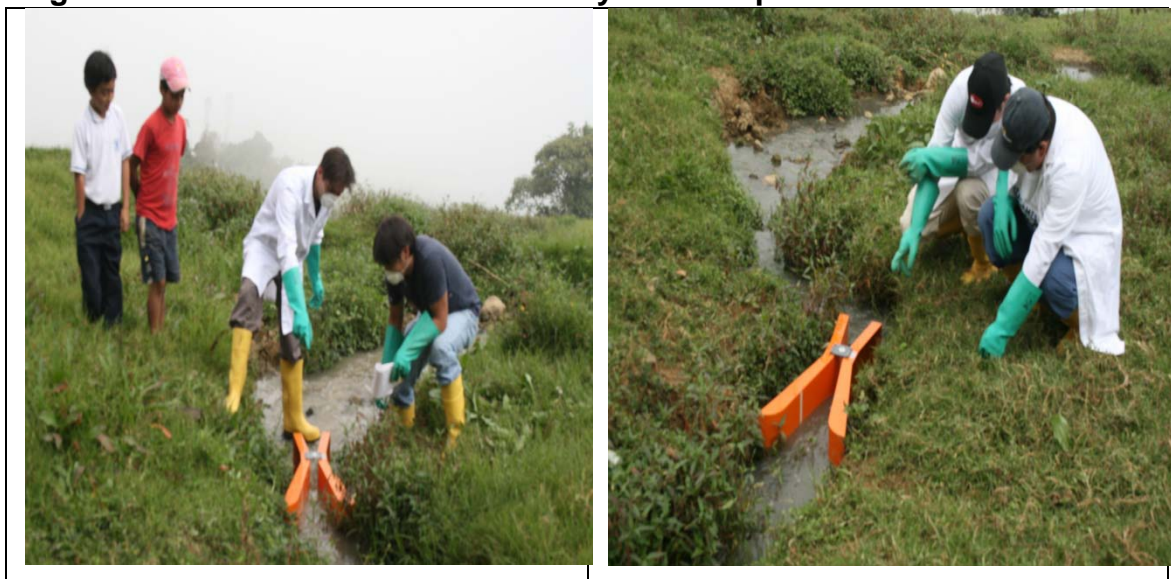
Figura 3.3. Adecuación de la canaleta y lecturas piezométricas
