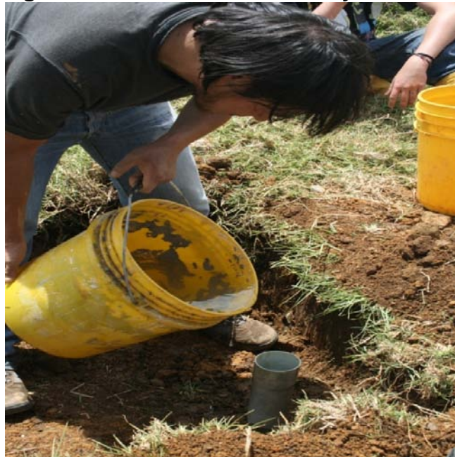
Figura 5.5. Realización del ensayo Lefranc
