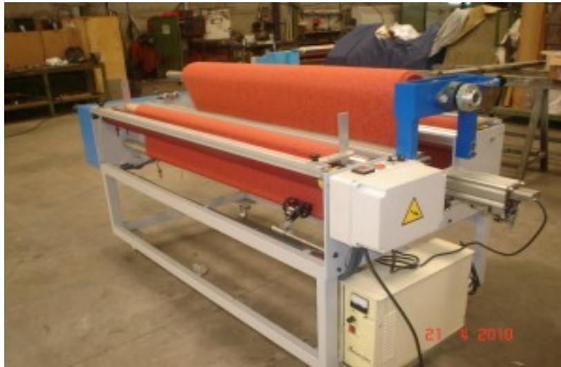
**Figura 15. Máquina para enrollar telas**
