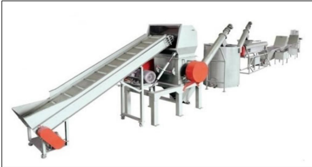
**Figura 11.** Máquina para lavar el PET reciclado
