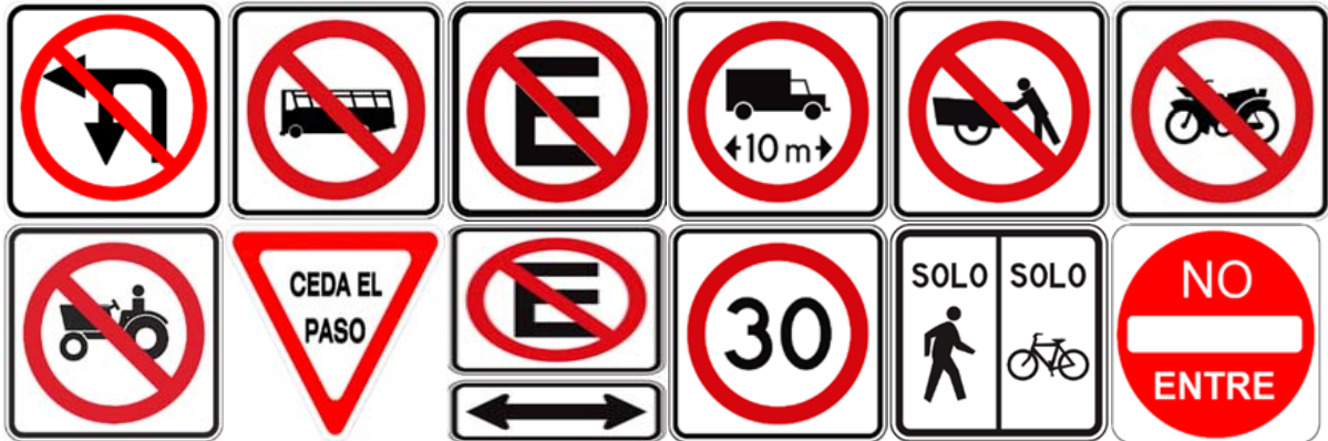
Figura 2.14. Señales verticales reglamentarias.
