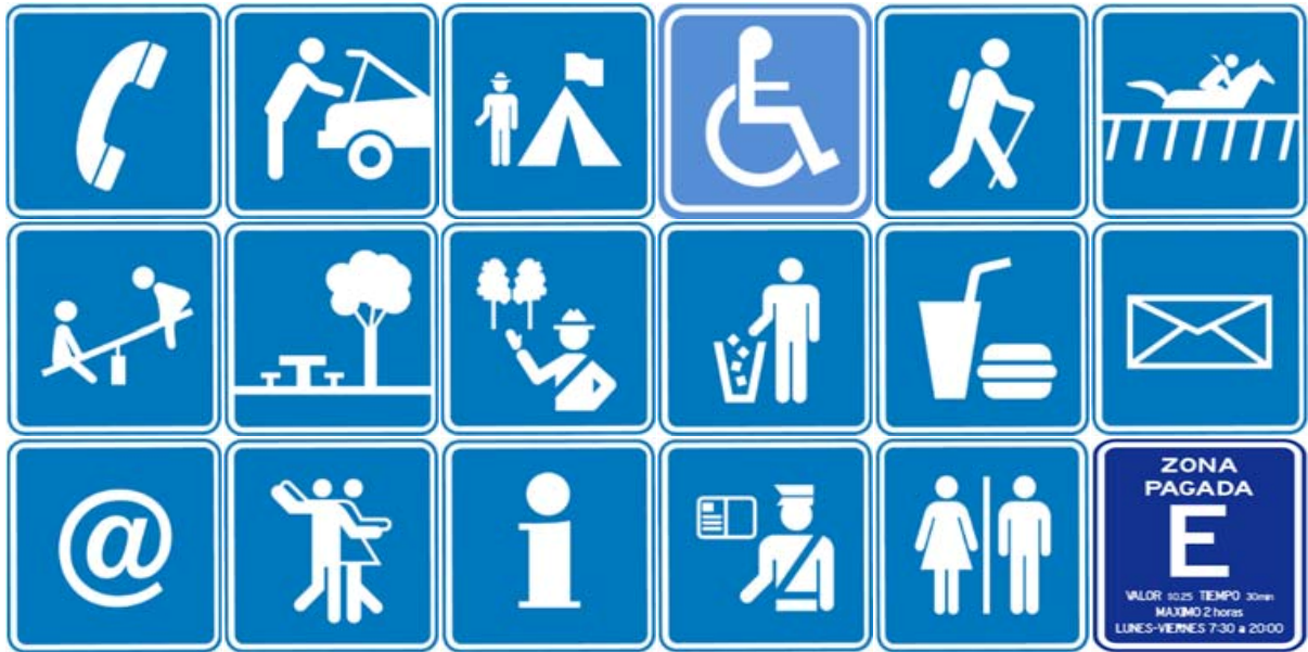
Figura 2.17. Señales verticales informativas de servicio.
