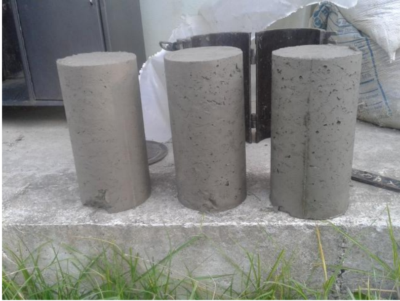
Ilustración 21. Desencofrado de cilindros de hormigón.
