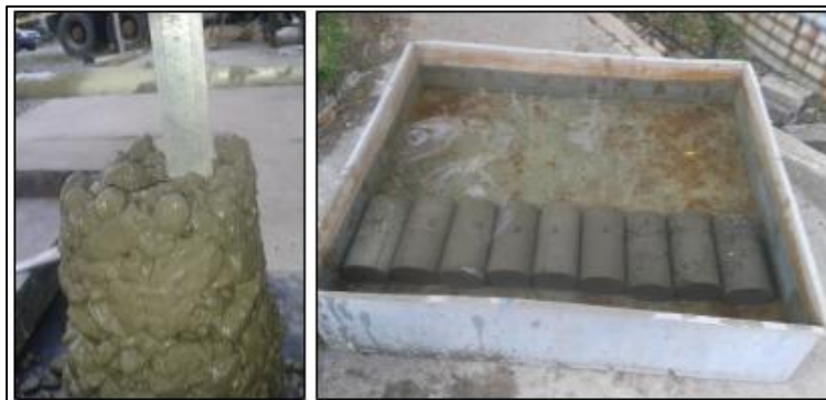
Ilustración 12. Elaboración y curado de cilindros de hormigón. Elaboración: El autor.
