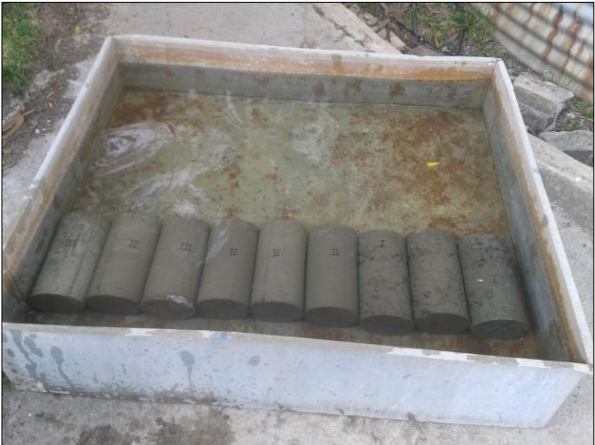
Ilustración 22. Cilindros de hormigón puestos a curación en piscina de agua.
