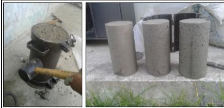
Ilustración 9. Elaboración de especímenes para ensayos. Elaboración: El autor.
