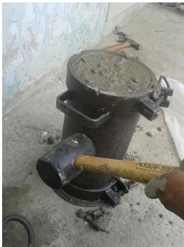
Ilustración 20. Elaboración de cilindros de hormigón.
