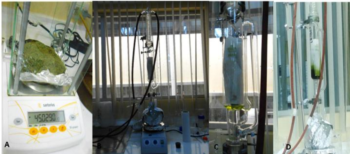
Figura 8. Extracción Soxhlet: obtención de un biopolímero a base de resina.(A) Pesaje de la muestra (B) Equipo Soxhlet armado (C) Proceso de extracción (D) Sifonadas. Elaborado: Sarango Y, 2016
