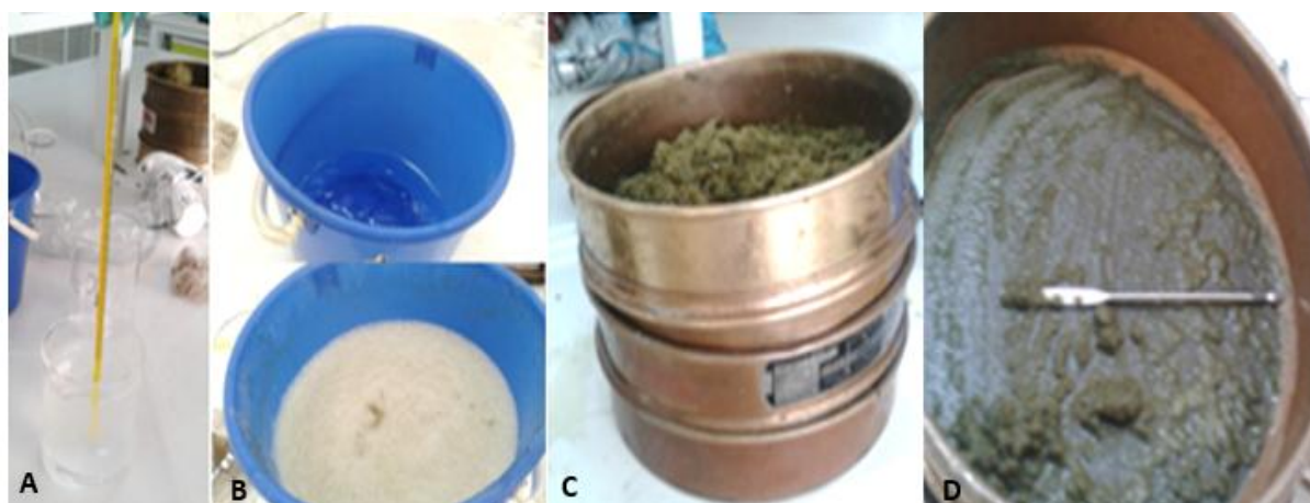
Figura 6. Extracción Hielo - Agua para la obtención de biopolímero de resina. (A) Medición de temperatura (B) Agitación de la muestra (C) Filtración (D) Resina atrapada.
