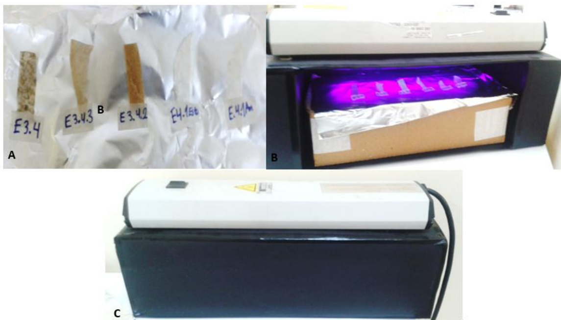
Figura 15. Exposición UV de biopolímeros. (A) Pesaje de los biopolímeros (B) Colocación de los biopolímeros en una caja oscura (C) Exposición de los biopolímeros a rayos UV. Elaborado: Sarango Y, 2016.
