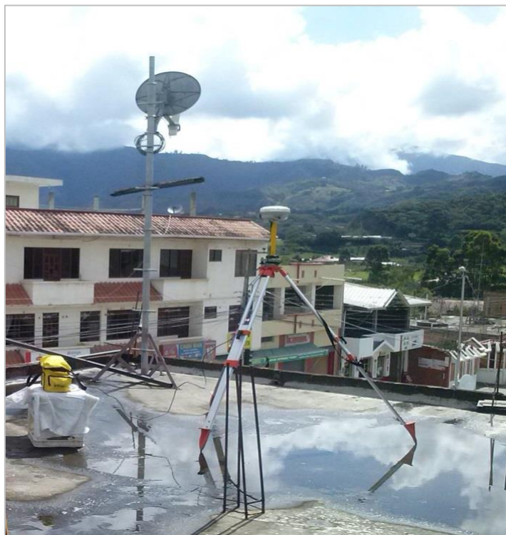
Foto 4. Estación base topográfica Malacatos. Fuente: La Autora.
