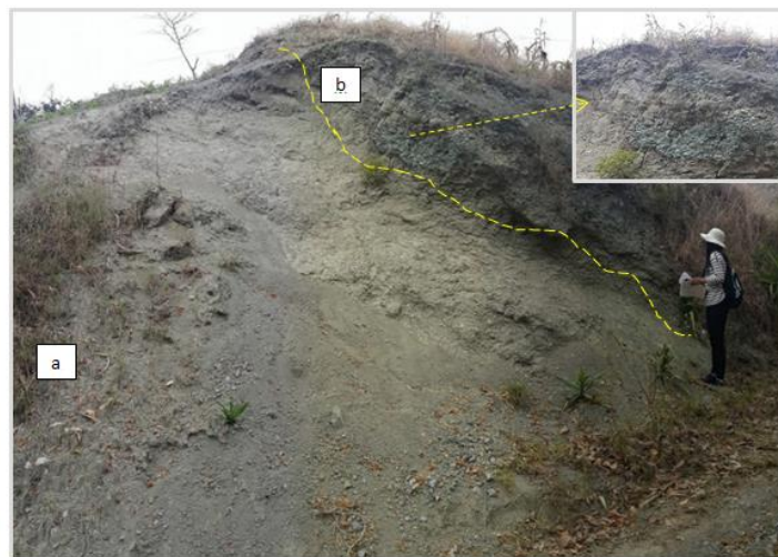
Foto 11. a) Arenisca calcárea altamente meteorizada. b) Micro - conglomerado englobado en una matriz arenosa calcárea. Fuente: La Autora.
