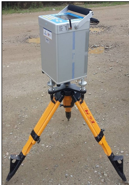
Figura 10. Gravímetro Scintrex CG-5 Autograv, UTPL. Fuente: La autora.
