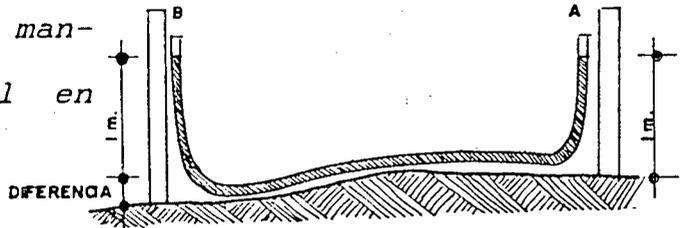
4. Encontrada ésta diferencia de altura, se la excava hasta dejar nivelado el terreno.
