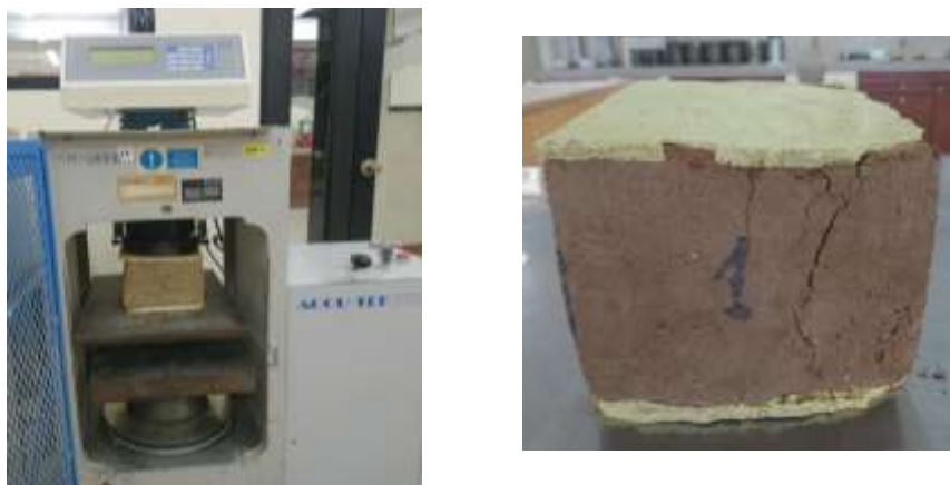
Figura 22: Determinación de la resistencia a compresión simple de un BT Fuente: El autor
