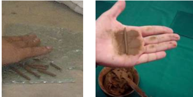
Figura 21: Determinación del límite plástico Fuente: El autor
