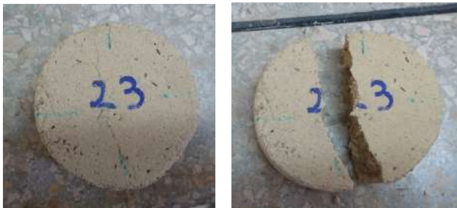
Figura 27: Fisuras producidas en las probetas luego del ensayo de tracción indirecta Fuente: El autor
