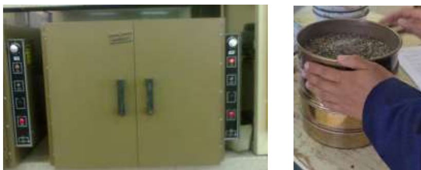
Figura 19: Análisis granulométrico del suelo mediante tamizado Fuente: El autor
