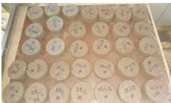
Figura 24: Probetas del suelo proveniente de Macará para ensayo de tracción indirecta Fuente: El autor
