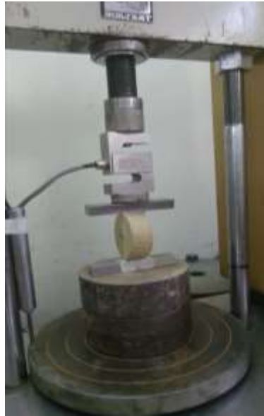
Figura 26: Ensayo de tracción indirecta Fuente: El autor
