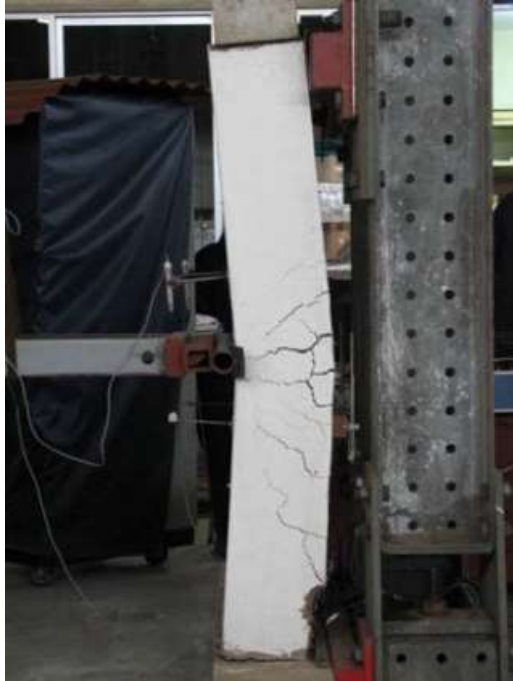
Figura 39: Sexta y última fase del ensayo a flexión realizado en los muros Fuente: Solís et al. (2015)
