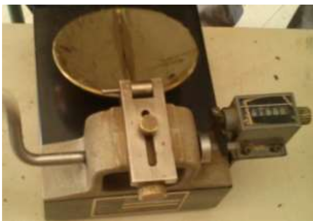
Figura 20: Equipo de Casagrande para determinación del límite líquido Fuente: El autor
