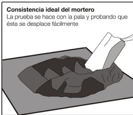
Figura 44: Consistencia ideal del mortero.
