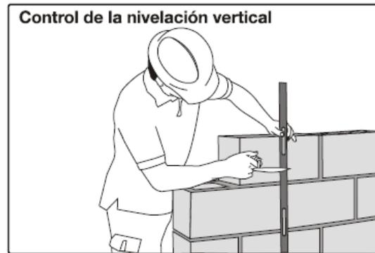
Figura 50: Nivelación vertical del Bloque con un nivel de al menos 1.20m de longitud.
