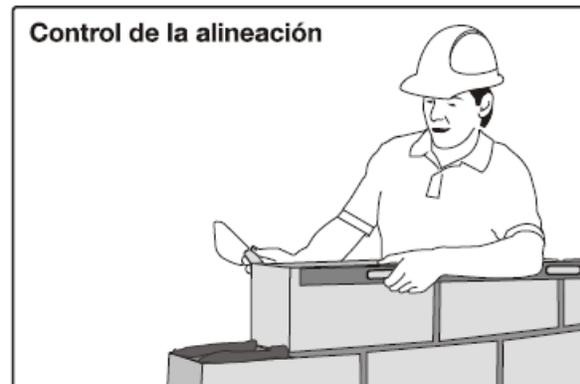
Figura 47: Alineado longitudinal del Bloque.
