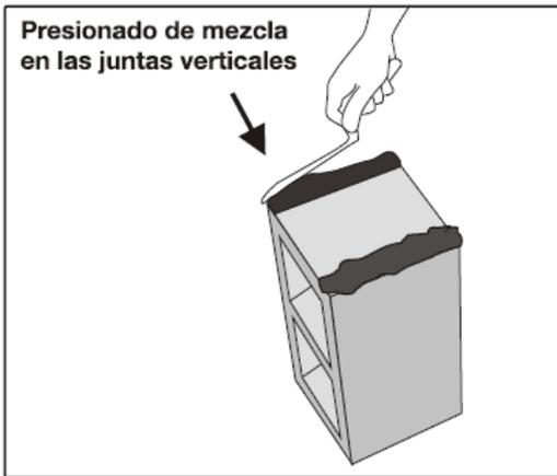
Figura 58: Presionado de mezcla en las juntas verticales del bloque.
