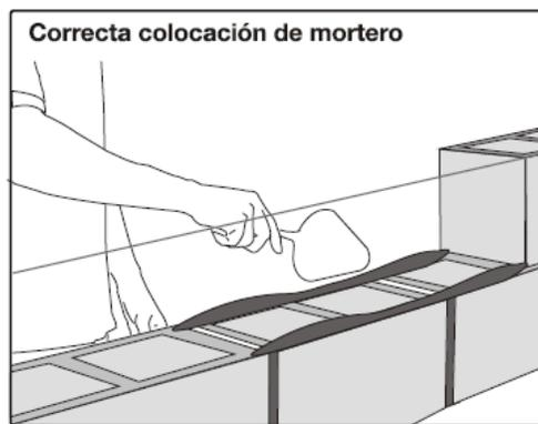
Figura 55: Correcta colocación del mortero.
