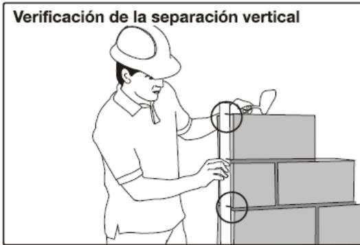
Figura 49: Verificación de bloque según la separación vertical deseada.
