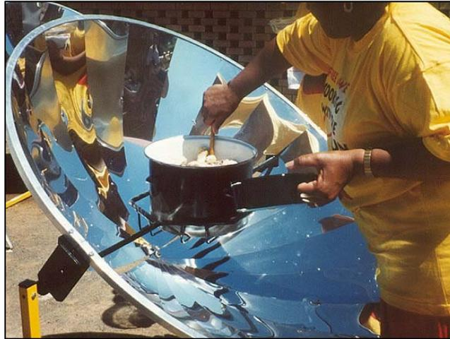
Figura 32: Cocina Solar Parabólica.
