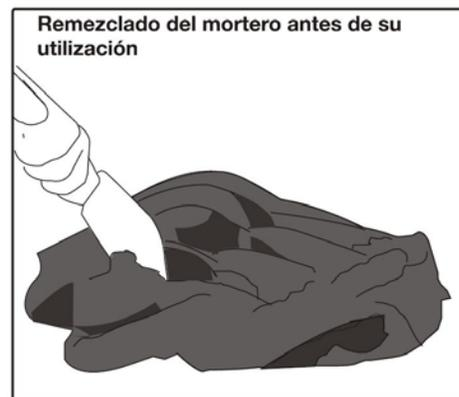
Figura 45: Remezclado del mortero antes de su utilización.
