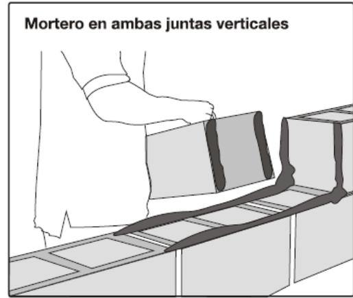
Figura 57: Mortero en ambas juntas verticales.
