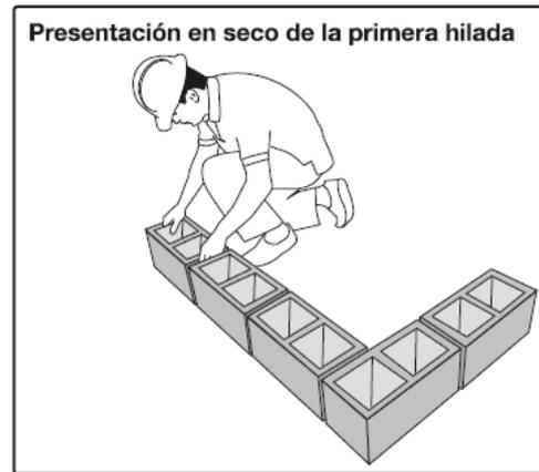
Figura 41: Armado de la primera hilada.
