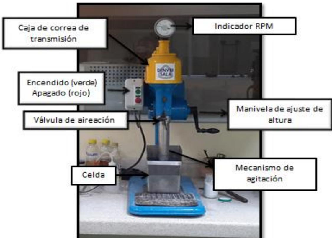
**Imagen 13.-Celda de flotación.**
