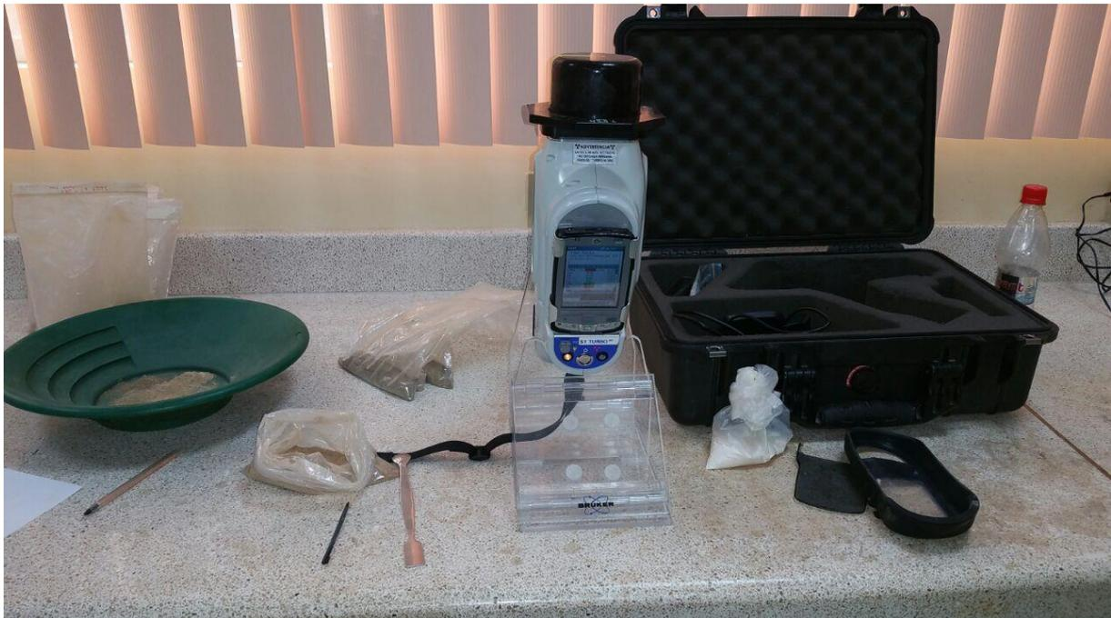
Figura 13. Equipo de Fluorescencia de Rayos X marca Brucker S1, utilizado para el análisis de las muestras.
