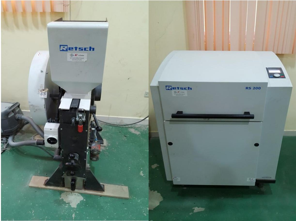
Figura 11. Trituradora Retsch BB200 WC y Pulverizadora Retsch RS 200, utilizadas para la preparación de las rocas en el laboratorio.
