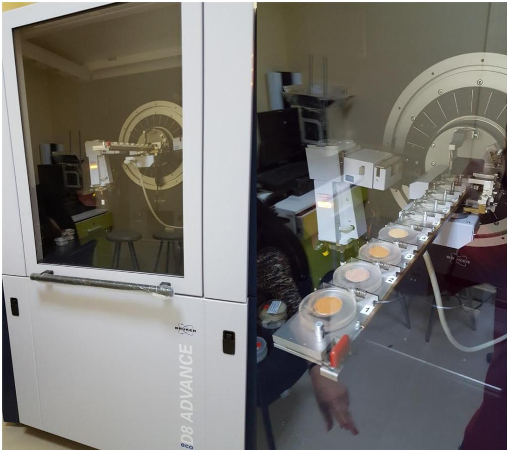
Figura 12. Equipo de Difracción de Rayos X modelo Bruker D8 Advance, utilizado para el análisis de las muestras en el laboratorio.
