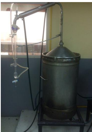
FIGURA 11. Equipo de destilación.
