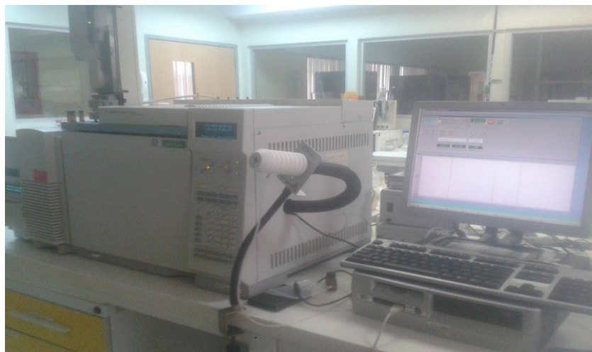
FIGURA 21. Cromatógrafo de Gases Agilent serie 6890N, acoplada a un espectrómetro de masas Agilent serie 5973 Inert
