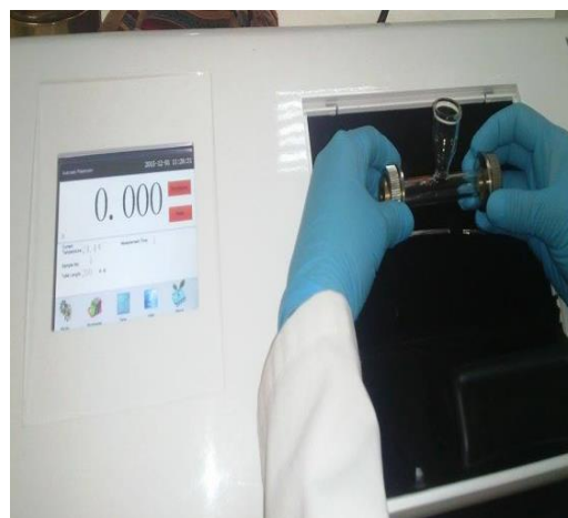
FIGURA 18. Celda del polarímetro
