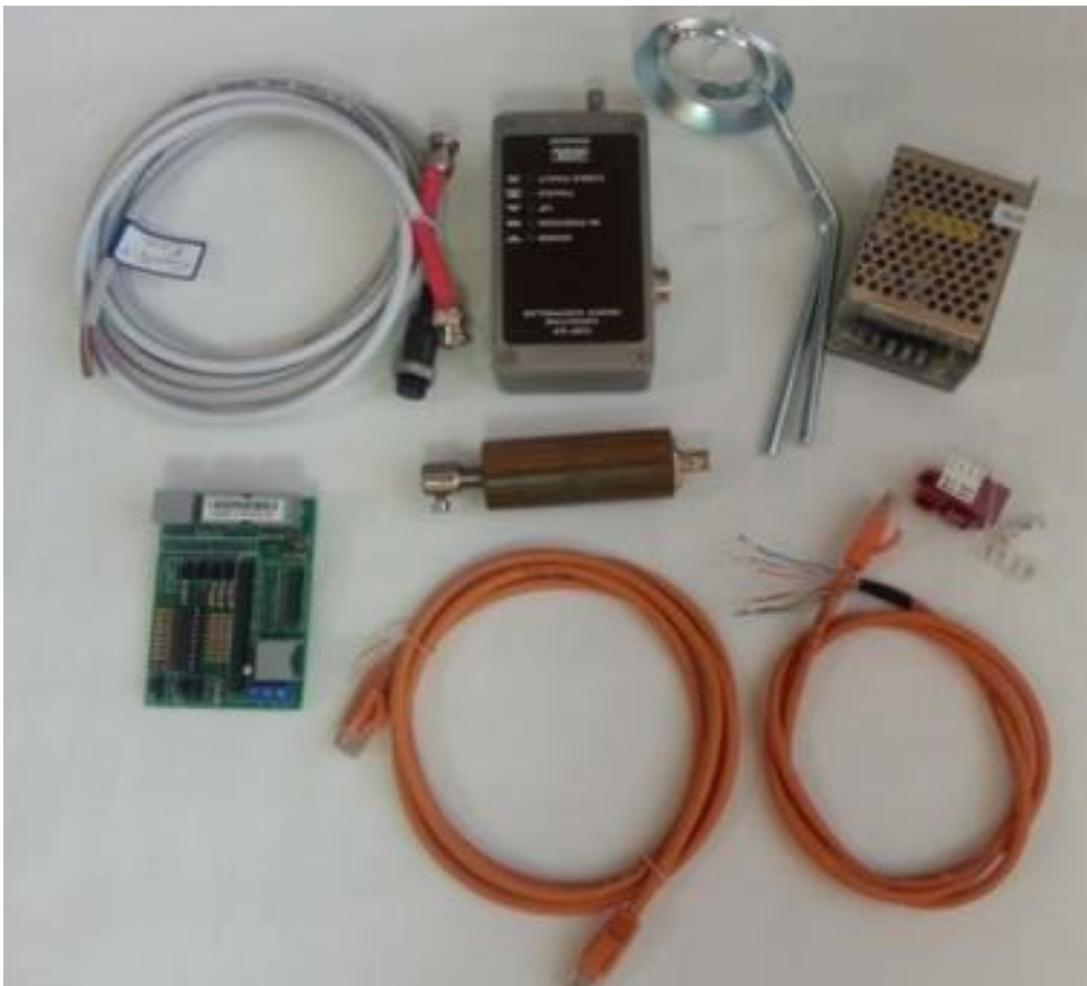
Figura 27: Componentes del sistema THC marca AGELKOM modelo CAP04
