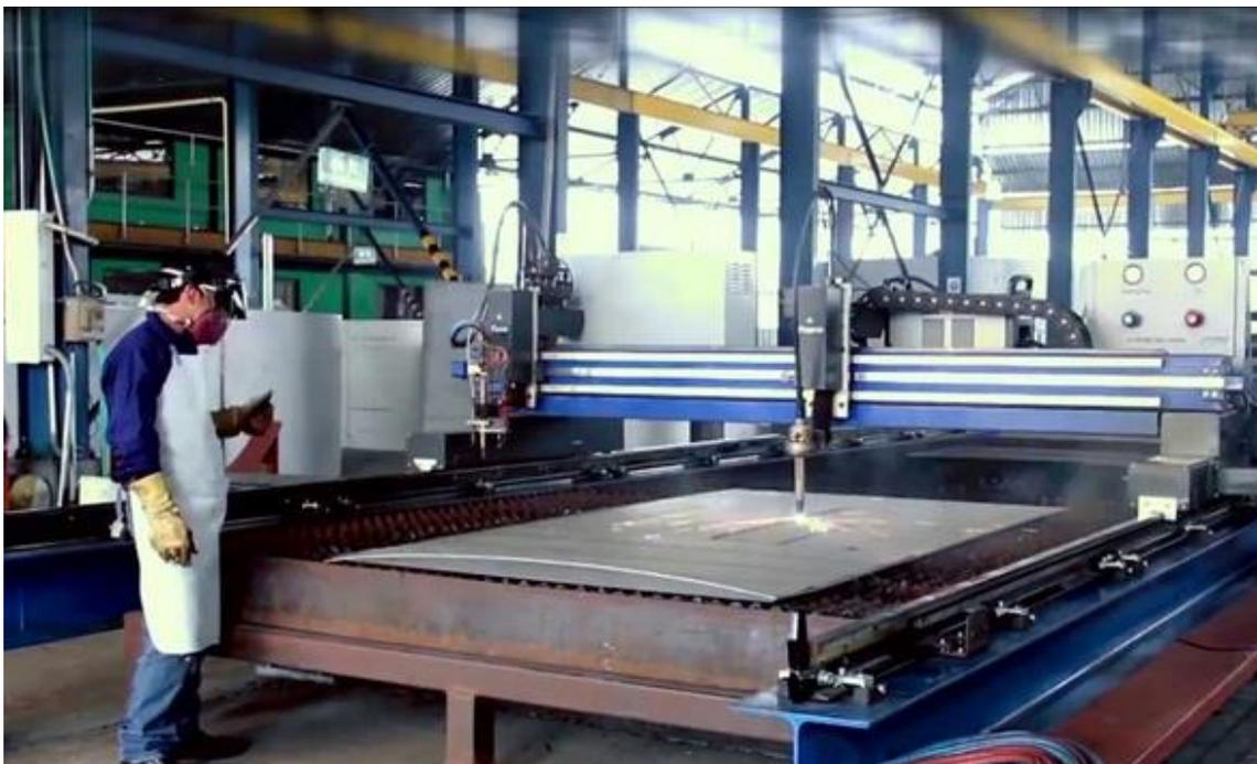
Figura 21: Mesa de Coordenadas para Corte por Plasma
