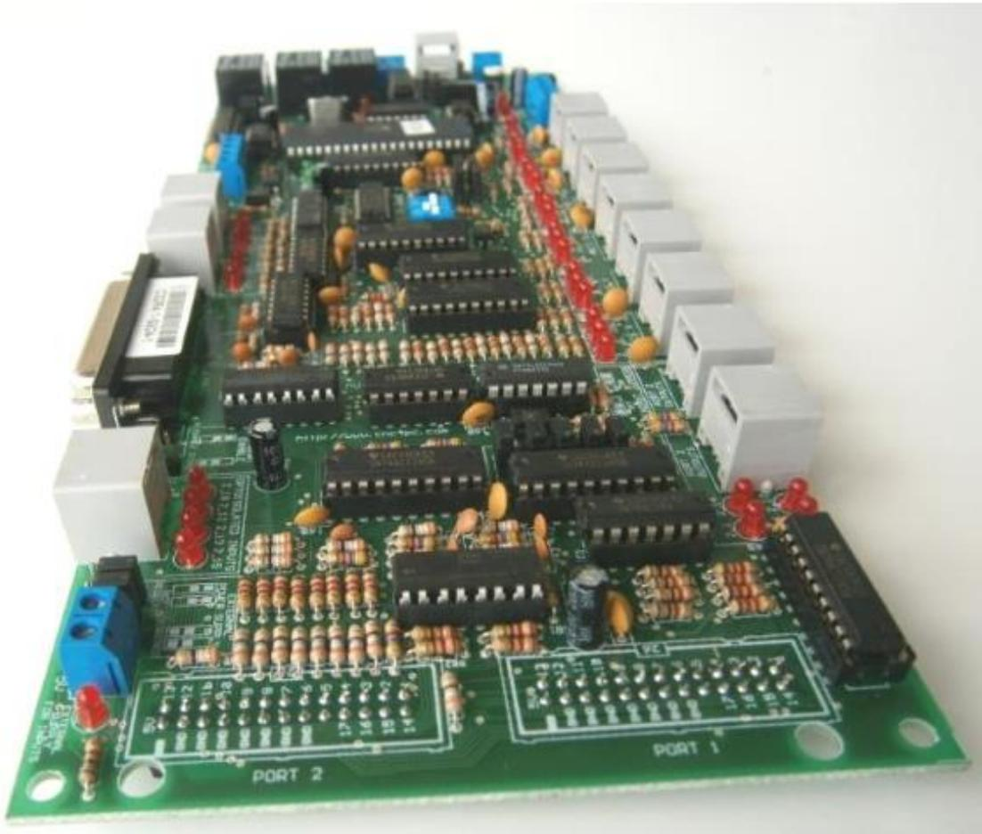
Figura 28: Tarjeta Interfaz marca CNC4PC modelo C32s
