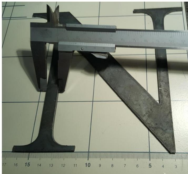
Figura 56: Verificación de medidas en el trabajo obtenido
