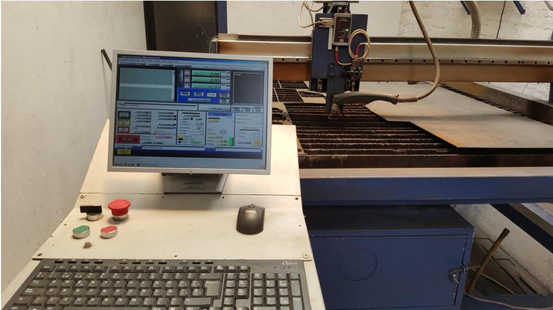
Figura 34: Equipo de control instalado en la MCCP
