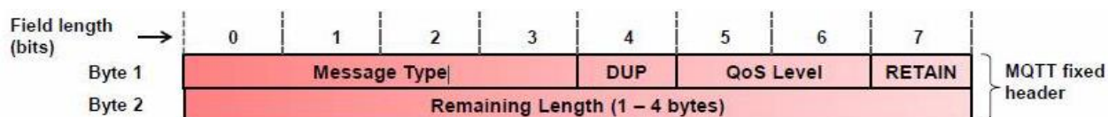
Figura 40: Estructura de la cabecera fija Fuente: Tomada de MQTT Versión 3.1.1. (OASIS, 2013)
