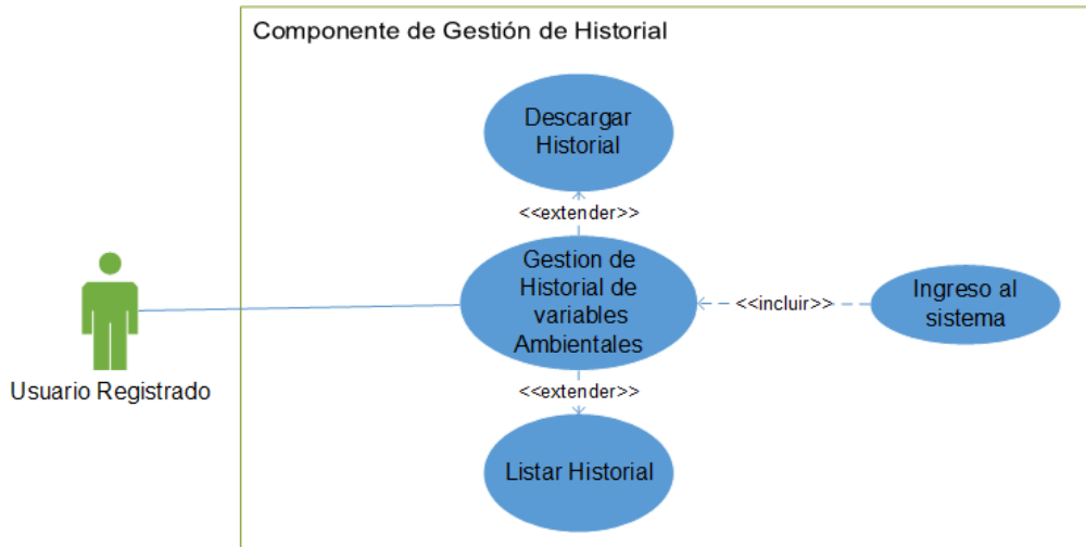
Figura 51: Diagrama de casos de uso - componente de historial Fuente: Elaborado por los autores.
