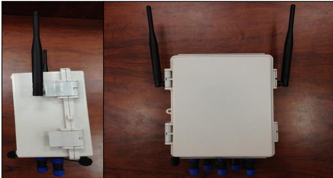
Figura. 4.32 Caja de protección de la plataforma.
