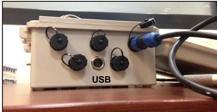
Figura. 4.35 Vista del conector nano USB.
