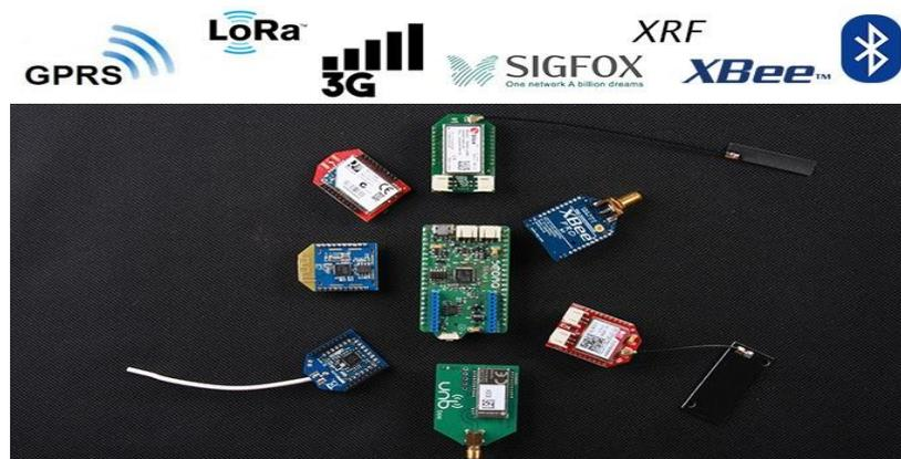
Figura. 3.17 Módulos de comunicación en formato XBee.
