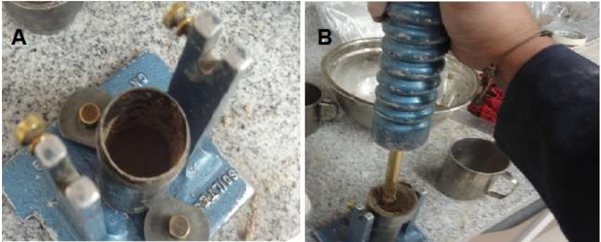
Gráfico 43. Capa compactada (A). Compactación final con 25 golpes (B) Fuente: El Autor
