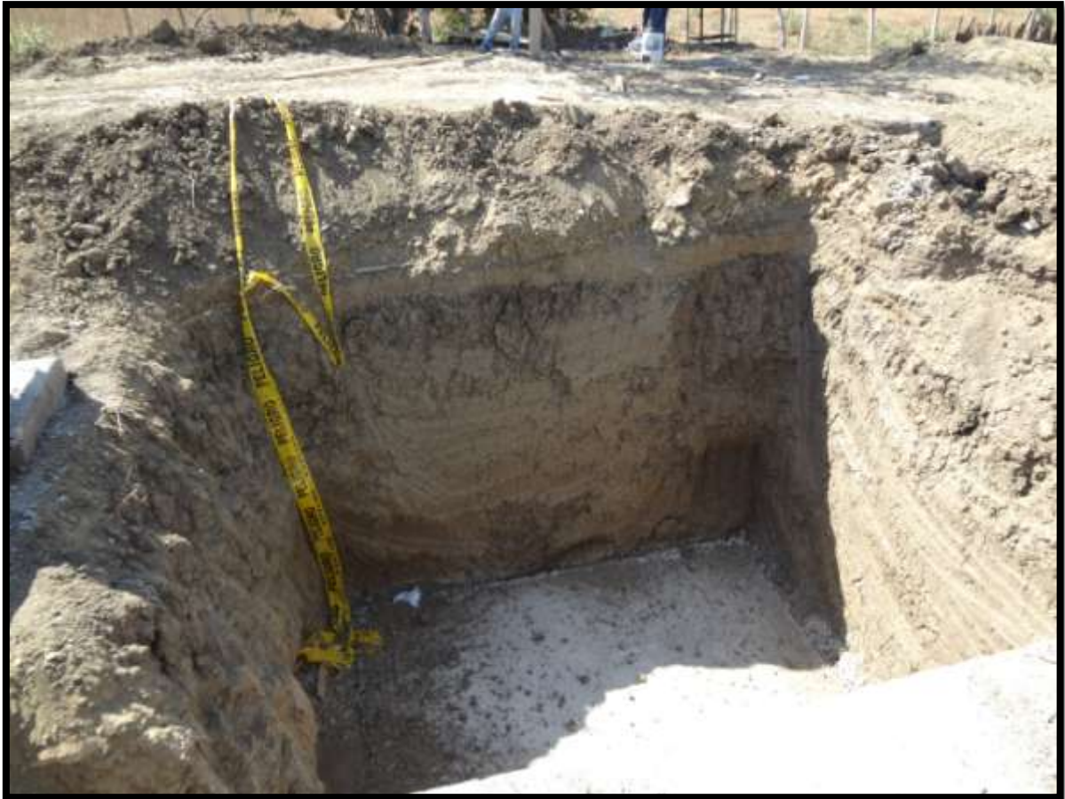
Gráfico 31. Calicata hecha para reserva de agua, arcilla café sin presencia de diatomitas Fuente: El Autor
