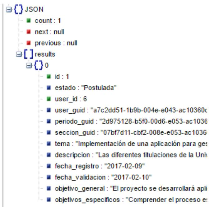
Figura 18. Salida servicio REST formato JSON.
