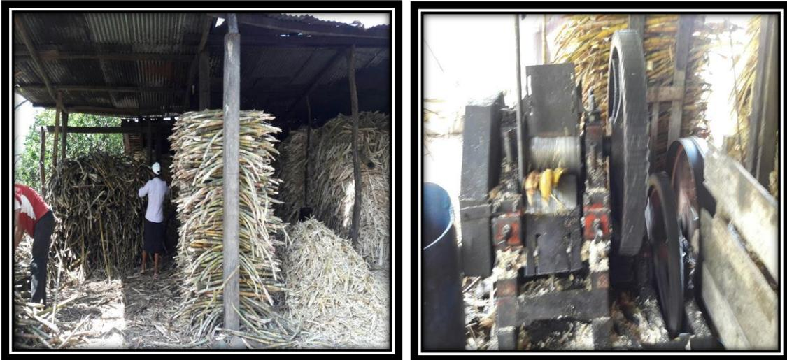
**Figura 10.** Molino de caña de azúcar
