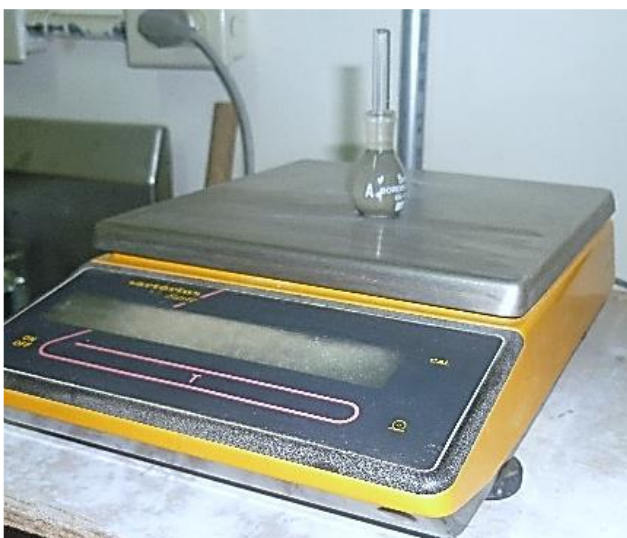
Figura 33: Método del picnómetro Fuente: Autor. Elaboración: Autor
