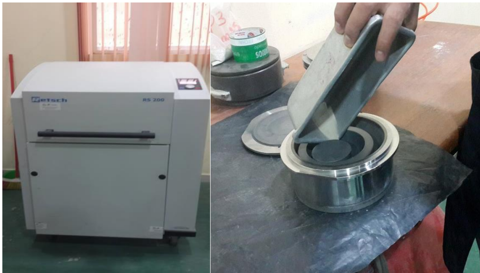
Figura 31: a) Pulverizador RETCH modelo RS1. b) Moldes del equipo pulverizador.
