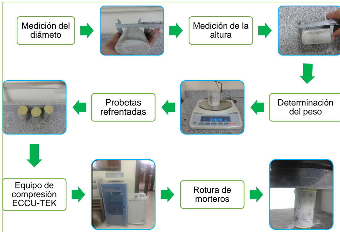
Figura 39: Síntesis del proceso después del curado. Fuente: Autor. Elaboración: Autor.
