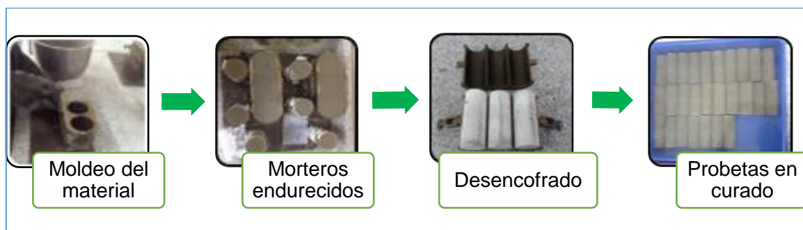
Figura 38: Moldeo y fraguado de las probetas.
